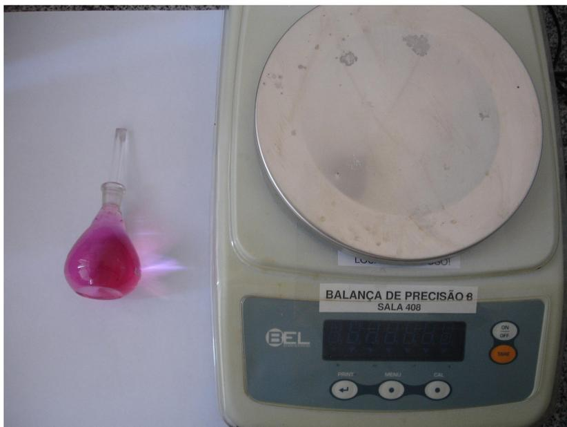
**FIGURA 5 - Foto do Picnômetro e Balança**
