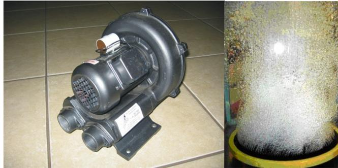
Figura 4.6 – (a) Soprador (b) Difusor de Membrana.
