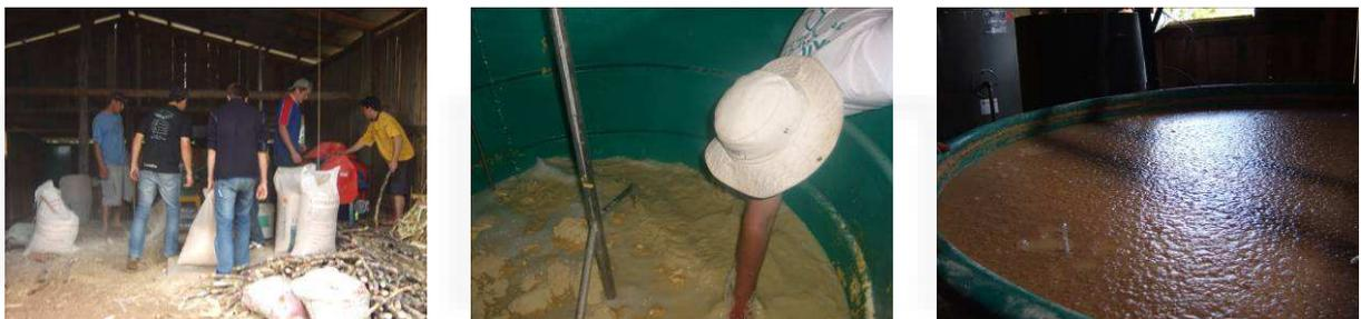
Figura 3 - Da esquerda para a direita: fotografias da moagem do milho; formação do mosto de milho; coleta de dados- grau de açúcar e temperatura do mosto.
