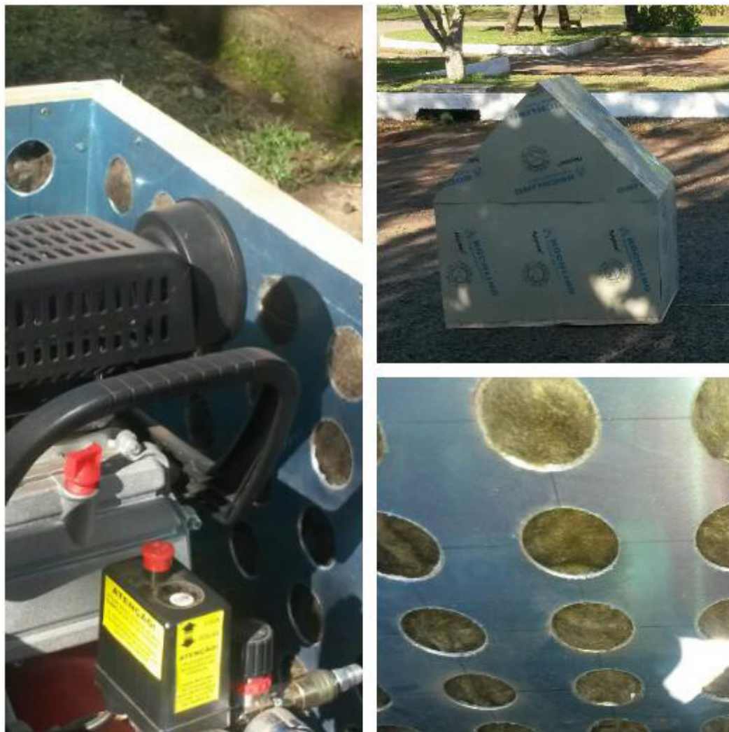
Figura 10 - Fotografia do protótipo da solução para isolamento acústico com a fonte de ruído não padronizada no interior (compressor de ar)
