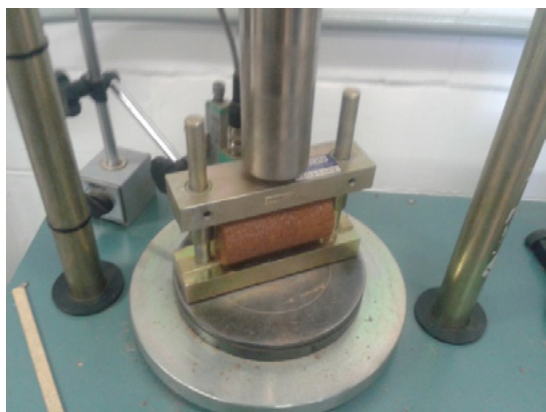
Figura 2 - Disposição do corpo de prova submetido à tração por compressão diametral na prensa
