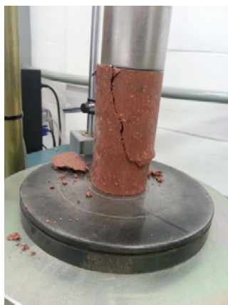
Figura 9 - Corpo de prova submetido à compressão simples
