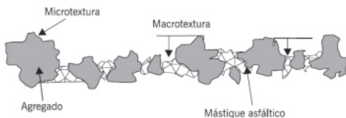
Figura 1 - Representação da macrotextura e microtextura (Bernucci et al,2010)
