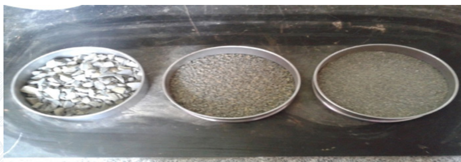
Figura 1 – Agregados minerais utilizados na pesquisa: a) brita 3/4", b) pedrisco e c) areia artificial
