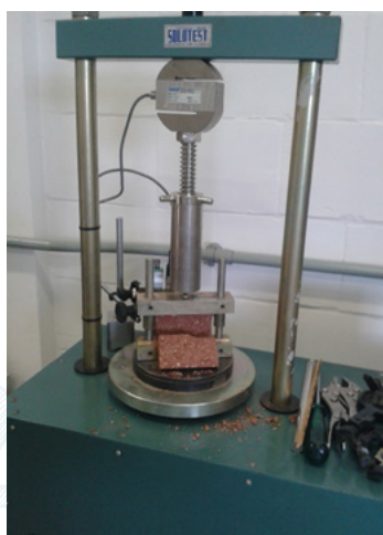
Figura 12 - Corpo de prova rompido por compressão diametral.
