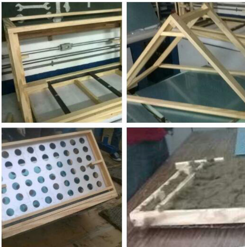
Figura 9 - Fotografia da construção do protótipo da solução para isolamento acústico
