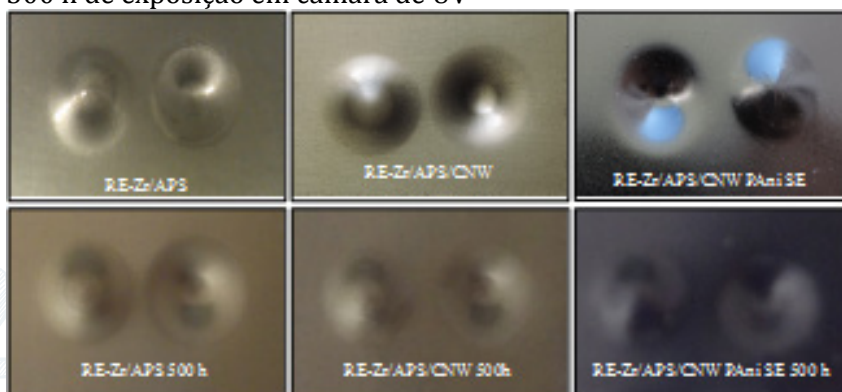
Figura 2 - Análise visual dos revestimentos submetidas ao ensaio de resistência ao impacto ante e após 500 h de exposição em câmara de UV
