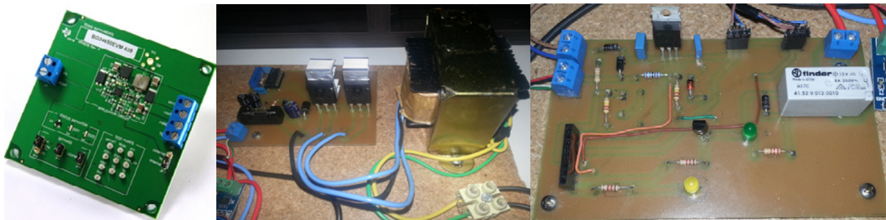
Figura 4 - Módulo controlador, inversor CC-CA e circuito de sensoriamento e proteção bateria
