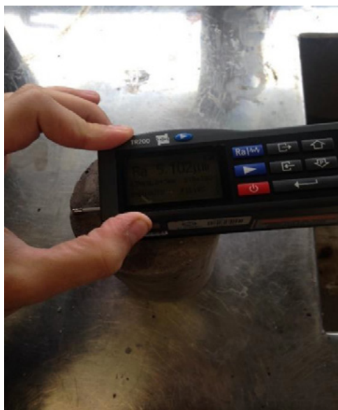
Figura 4 – Rugosímetro em processo de leitura da rugosidade da superfície
