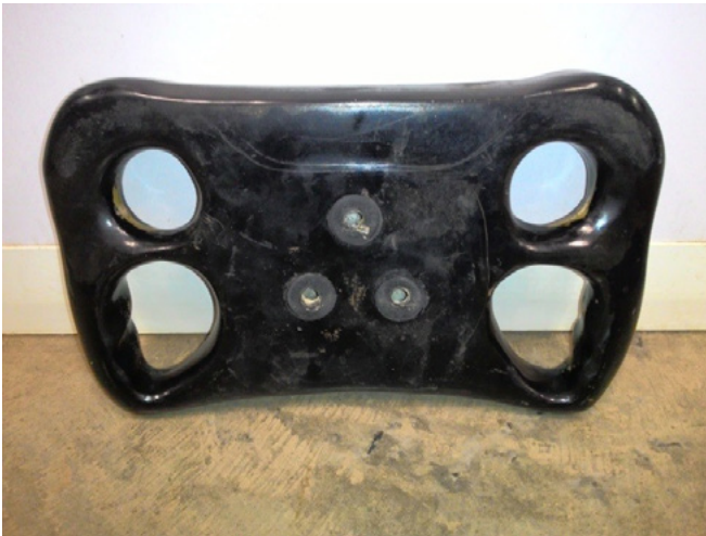
Figura 13 - Volante com massa 880 gramas.
