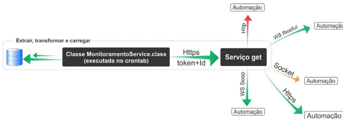
Figura 3 - Esquema técnico do processo de carregamento e transformação dos dados com protocolos de comunicação distintos;
