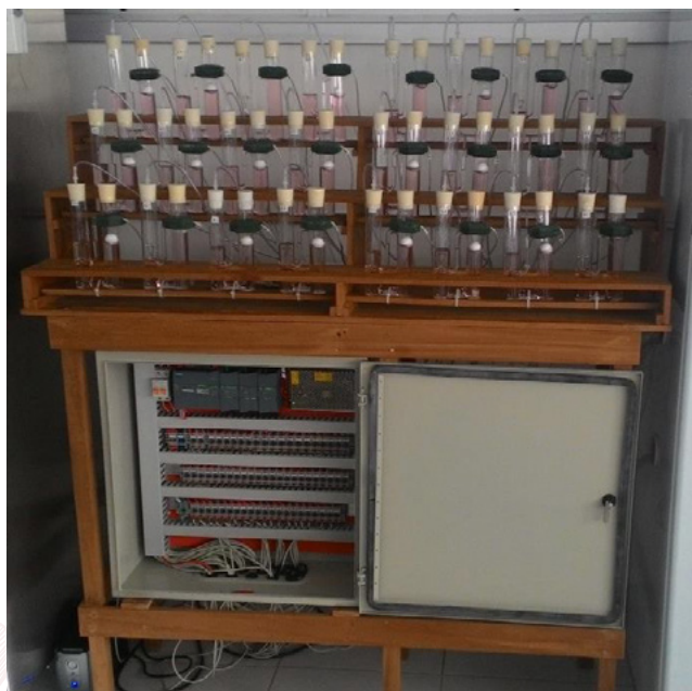
Figura 2 – Sistema automatizado de medição de biogás
