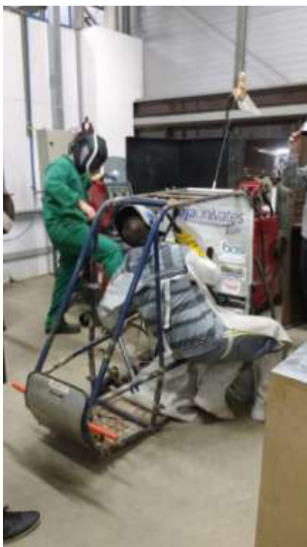
Figura 2: Dificuldade do aluno Rafael durante a soldagem na posição sobrecabeça.
