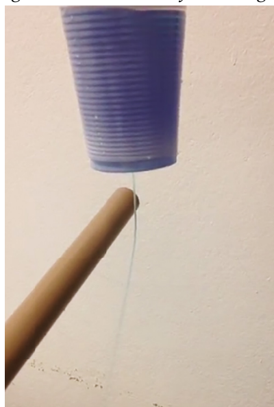
Figura 2.6 - Desvio do filete de água
