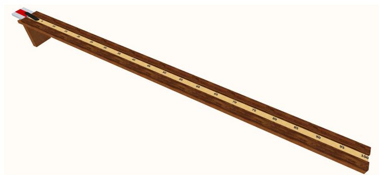
Figura 1 – Equipamento projetado para a prática de um skate descendo uma rampa ilustrativa
