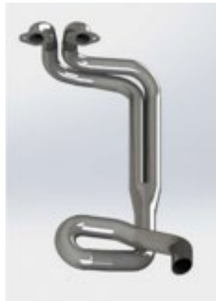
Figura 02 – Projeção do sistema final de escape em aço inoxidável SAE 304
