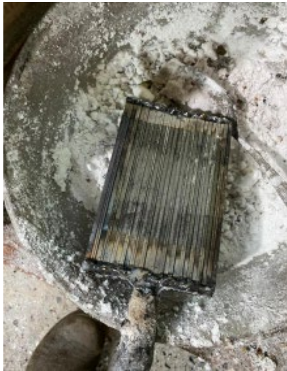
Figura 2: Aços empilhados em formato de sanduiche
