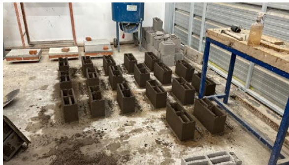
Figura 1. Produção de blocos de concreto com forma personalizada.
