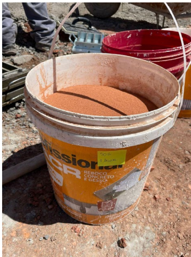
Figura 1. RCD Cerâmico após processo de moagem e granulometria.
