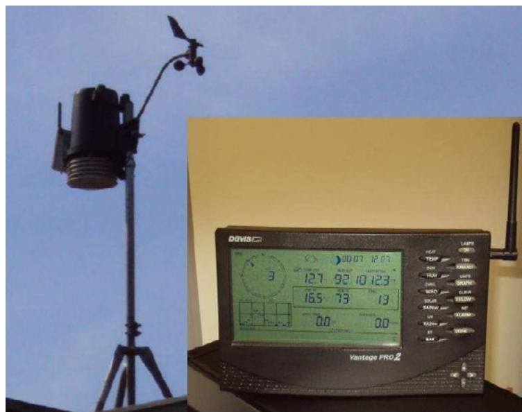
Figura 4: Estação meteorológica modelo DAVIS Vantage PRO 2
