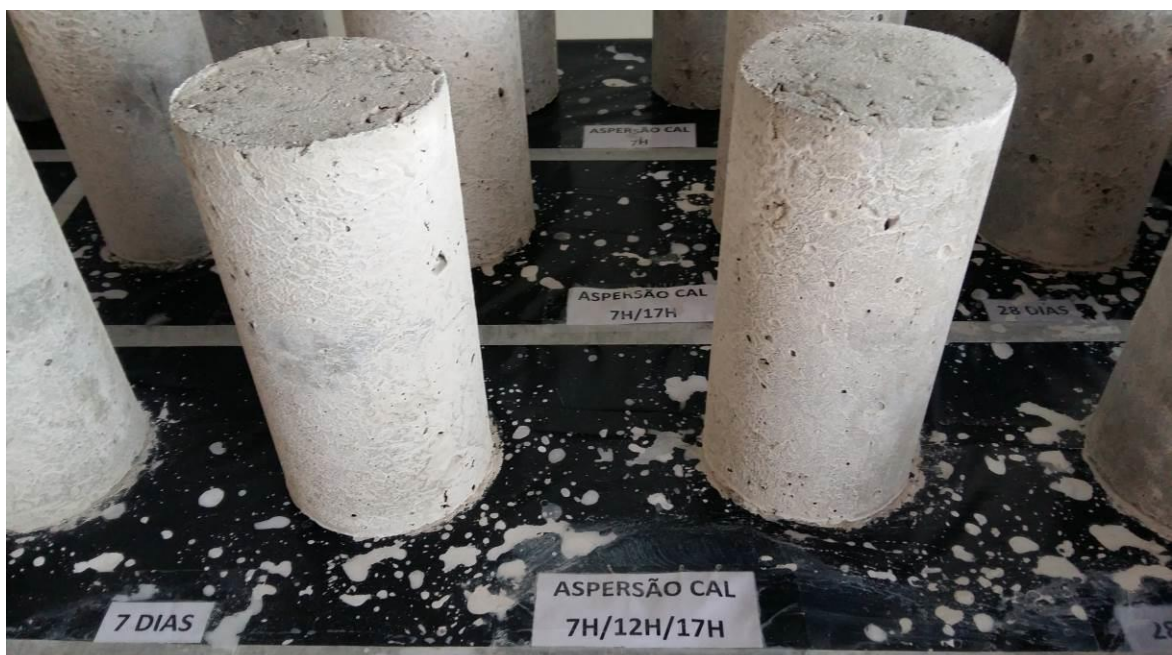
Figura 22 – Cura por aspersão periódica de cal hidratada dissolvida em água
