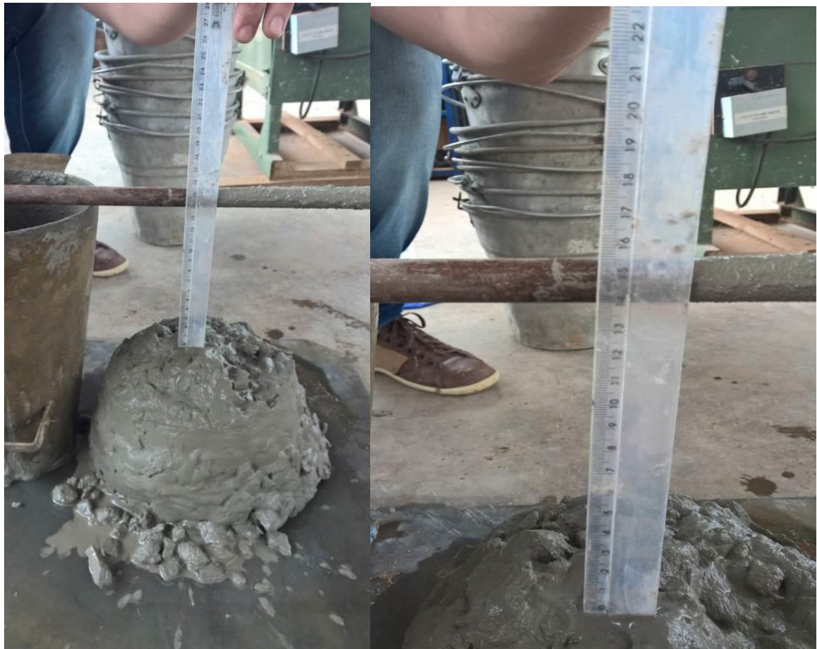
Figura 16 – Realização do ensaio de abatimento do tronco de cone
