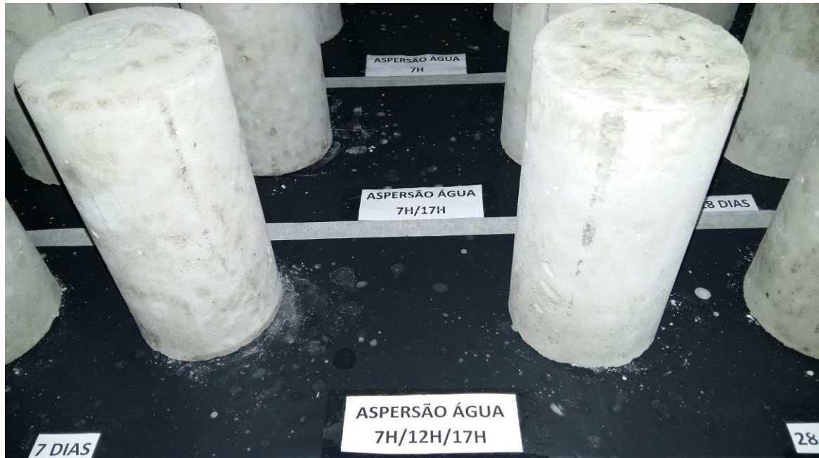
Figura 21 – Cura por aspersão periódica de água
