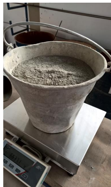
Figura 14 – Cimento sendo pesado e separado
