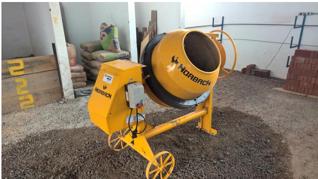
Figura 10 – Betoneira para a produção do concreto
