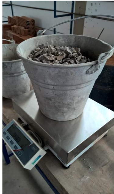
Figura 13 – Brita sendo pesada e separada
