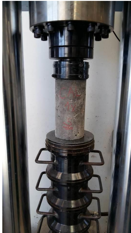
Figura 28 – Ensaio de compressão com corpo de prova 02
