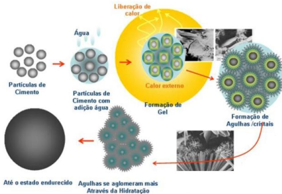
Figura 1 – Processo de hidratação do cimento
