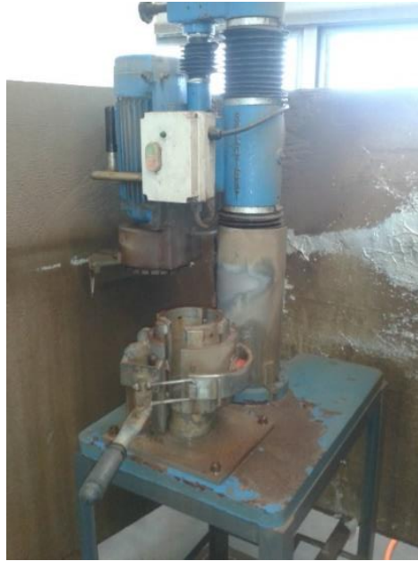
Figura 25 – Retífica de corpos de prova
