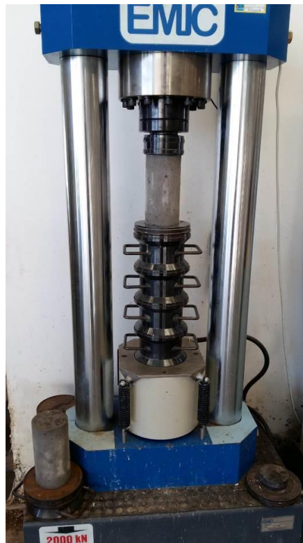
Figura 27 – Ensaio de compressão com corpo de prova 01
