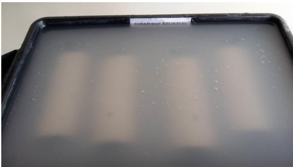
Figura 20 – Tanque de água saturada de cal hidratada
