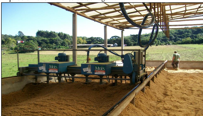
Figura 8 – Máquina Realizando a Operação de Aplicação de Dejetos Líquido e Revolvimento da Serragem.
