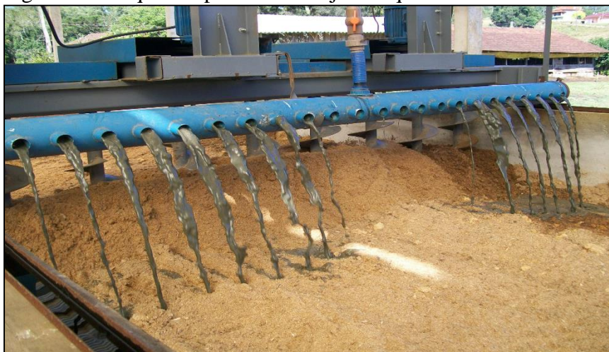
Figura 9 – Máquina Aplicando o Dejetos Líquido de Suínos.
