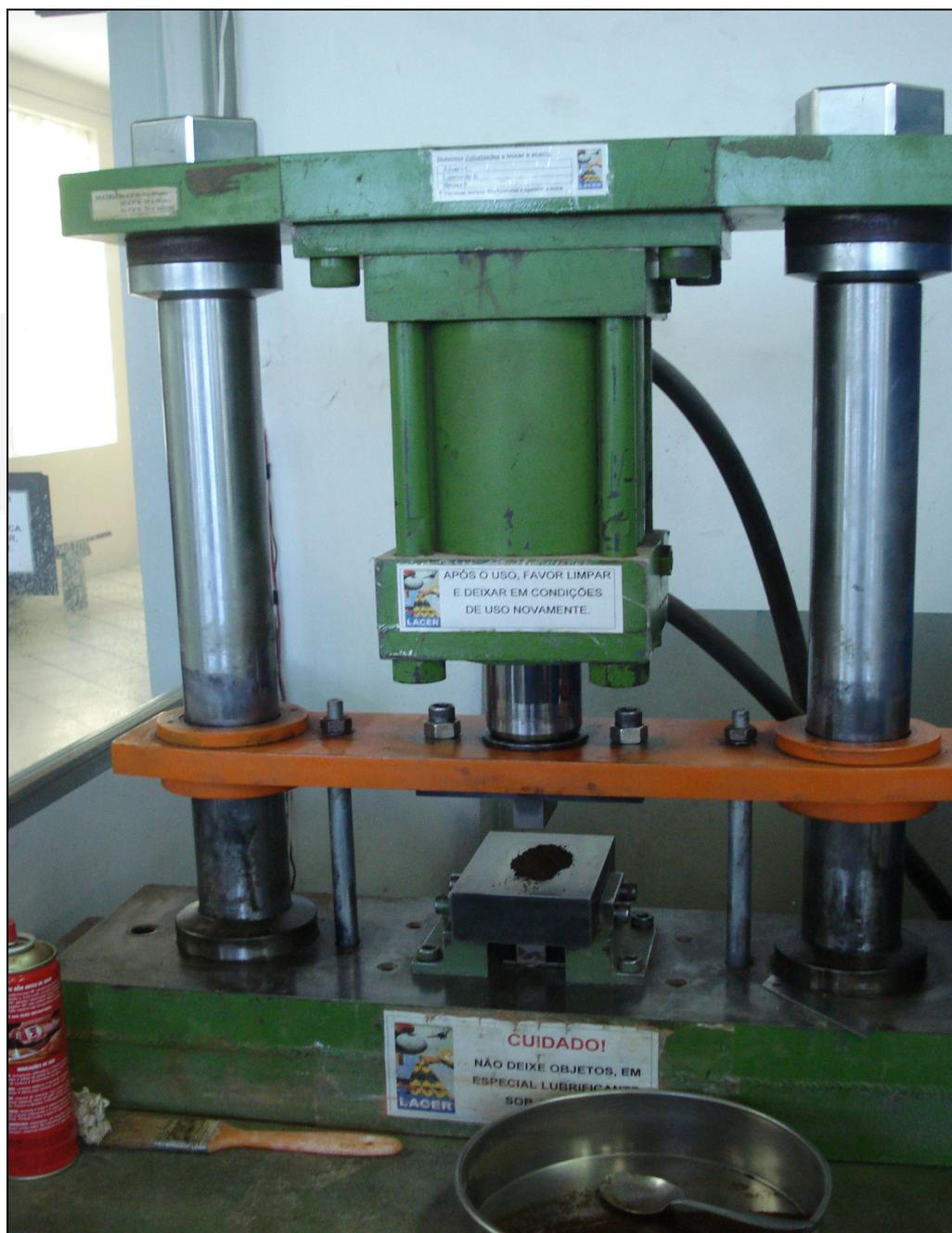
Figura 12 – Detalhe do molde em aço inox e da massa argilosa granulada, pronta para prensagem (A) e de um corpo de prova prensado (B).
