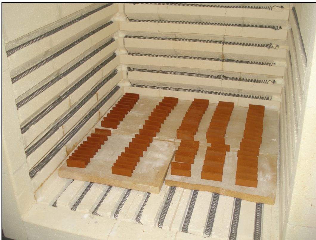
Figura 16 – Visualização de um corpo de prova, recém tirado da mufla.
