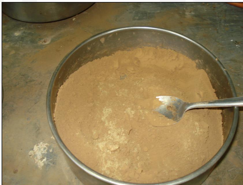
Com todas as formulações homogeneizadas, efetuou-se à etapa de peneiramento, no intuito de se obter uma massa argilosa granulada, assemelhando-se com o processo de atomização que ocorre nas indústrias (PUREZA 2004). A peneira utilizada possuía uma malha de 100 mesh (com abertura de 0,149mm). A figura 10 demonstra a massa argilosa granulada, após o peneiramento.
