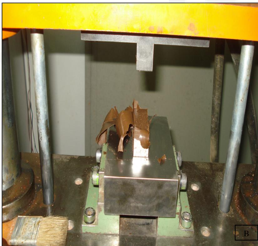
Após os corpos de prova prensados, os mesmos foram identificados quanto a sua formulação e sua sequência de produção. Em alguns casos com auxílio de estilete, foram retiradas as rebarbas existentes nos corpos de prova produzidos.
