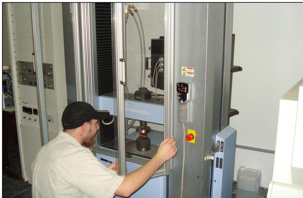
Figura 20 – Equipamento de ensaio universal SHIMADZU, mede à resistência mecânica à flexão em quatro pontos.
