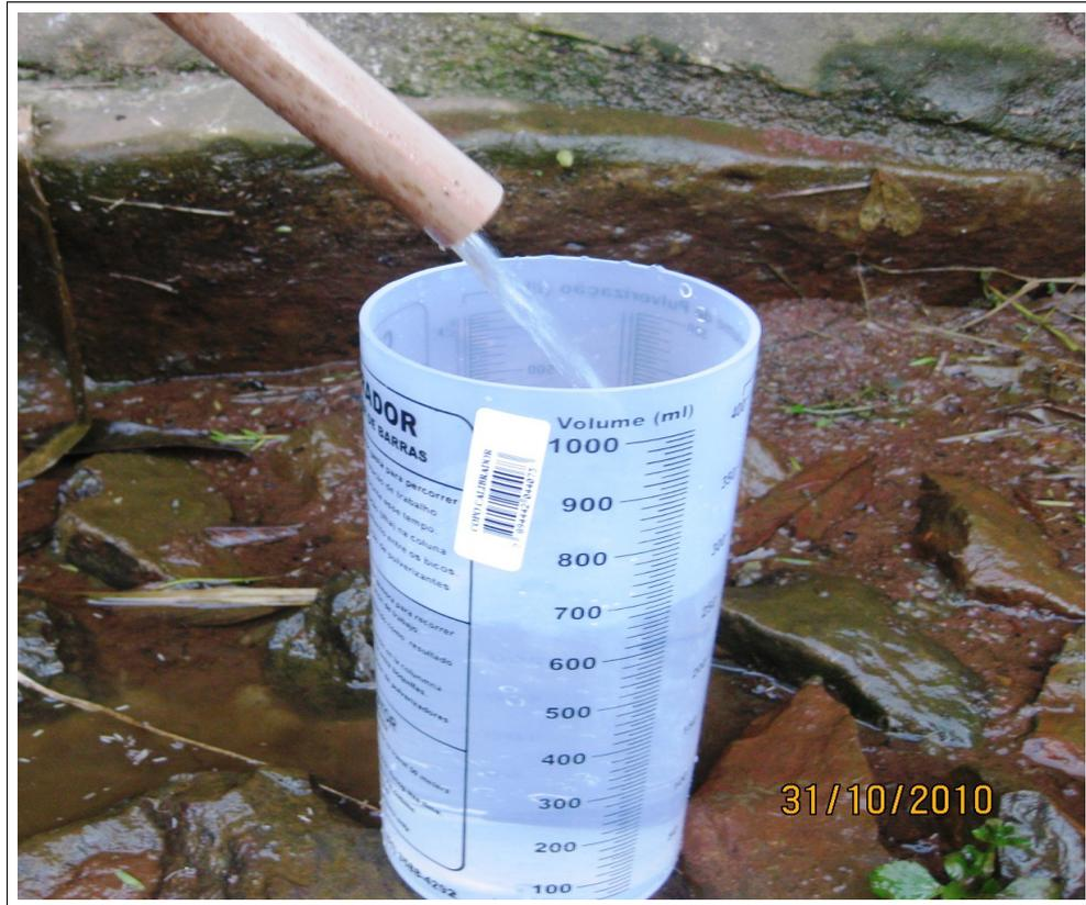
**Figura 25** Aferição da vazão de entrada no *wetland* construído com o uso do copo calibrador.
