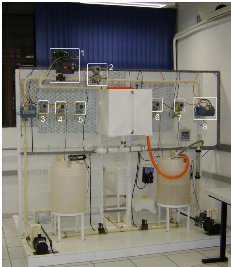
Figura 30 Dispositivos de campo distribuídos ao longo do canal Fieldbus1
