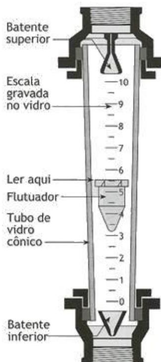
**Figura 5 Escala para rotômetros convencionais (DELMÉE, 2003)**
