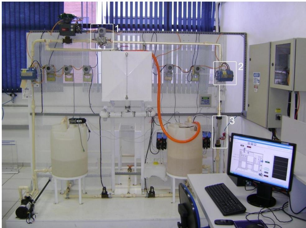
Figura 29 Medidores de vazão em série na tubulação
