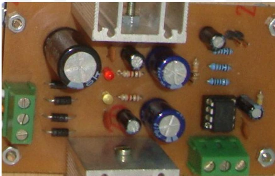
**Figura 23** Placa de condicionamento de sinal de vazão
