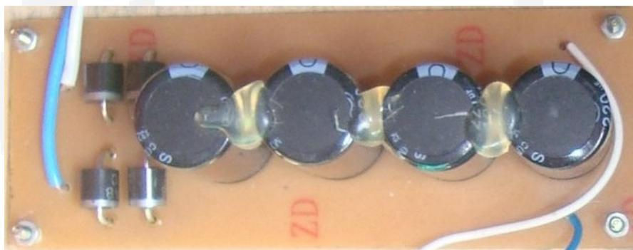
**Figura 48 Placa da fonte CC do inversor**
