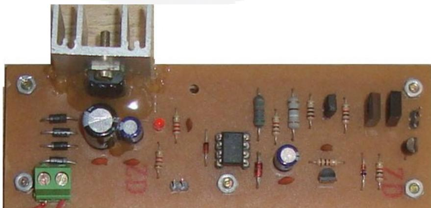
**Figura 44 Placa do *drive* do inversor**
