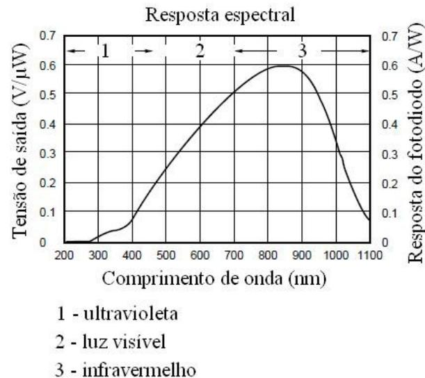
**Figura 25 Resposta espectral do OPT101 (adaptado de BURR-BROWN, 1994)**
