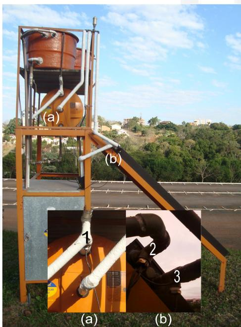
**Figura 13 Localização dos sensores PT100 da temperatura da água de consumo (a) e temperaturas de entrada e saída dos coletores (b)**
