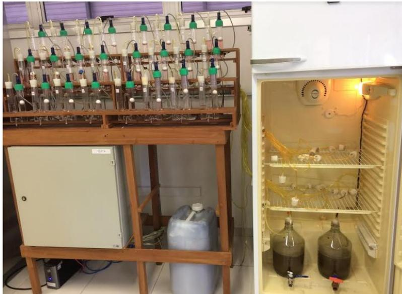
A quantificação do biogás gerado pelos reatores foi medida pelo deslocamento do fluido, que registra a passagem do biogás pelo sistema por meio de circuito eletrônico. Este sistema utiliza a equação combinada dos gases ideais, que prediz que a relação entre temperatura, pressão e volume de um gás é constante. Na Figura 11 é possível visualizar os tubos de realização e leitura de biogás do experimento.
