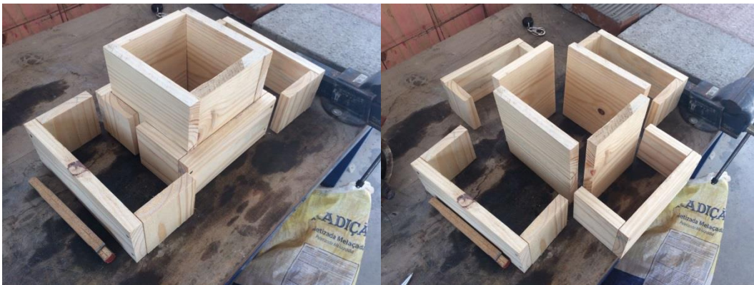
Figura 49 – Fôrma de madeira desenvolvida para este trabalho.
