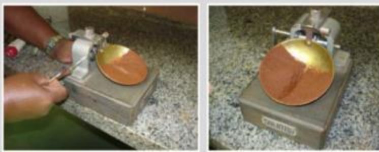
Figura 3 – Ensaio limite de liquidez, aparelho de Casagrande.
