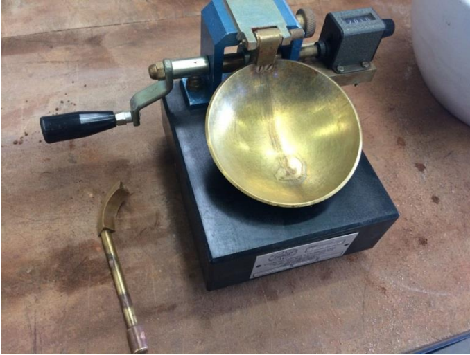
Figura 39 – Aparelho de Casagrande utilizado para ensaio do Limite de liquidez do solo utilizado.
