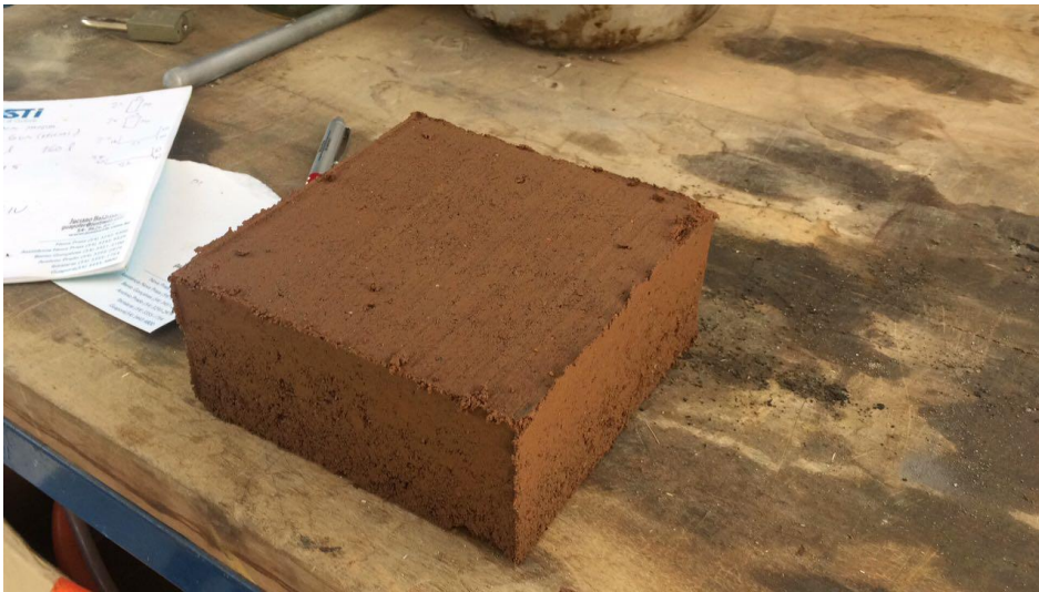
Figura 58 – Corpo de prova desformado após a compactação.
