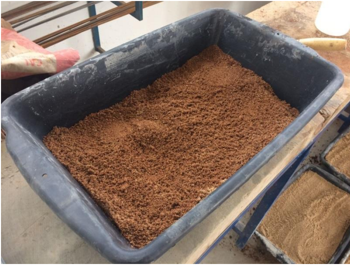
Figura 51 – Material homogêneo com areia e a argila.
