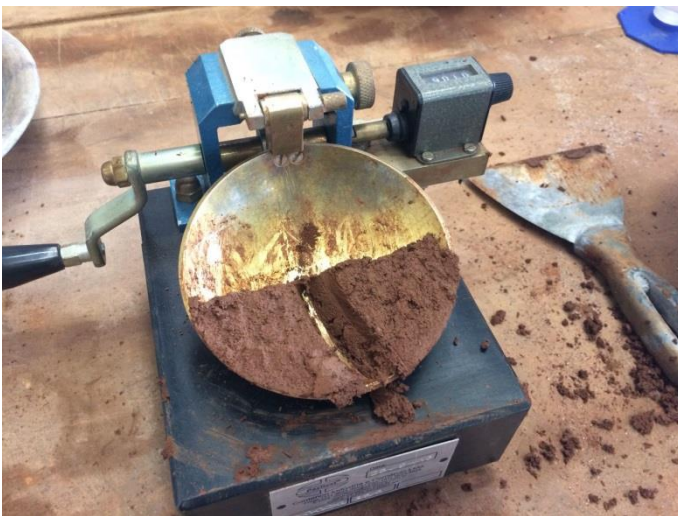
Figura 40 – Solo submetido ao teste com a ranhura aberta inicialmente.
