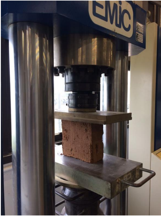
Figura 60 – Corpo de prova sendo submetido a resistência a compressão.
