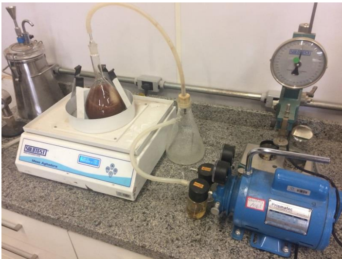
Figura 43 – Agitador do solo para caracterização em relação a massa específica do solo.
