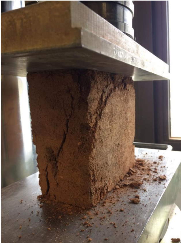
Figura 61 – Rompimento do corpo de prova.
