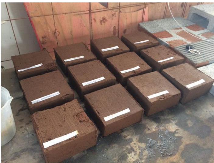
Figura 59 – Série de corpos de prova no seu tempo de cura.
