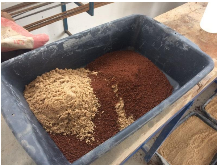
Figura 50 – Mistura dos materiais sem adição de água.
