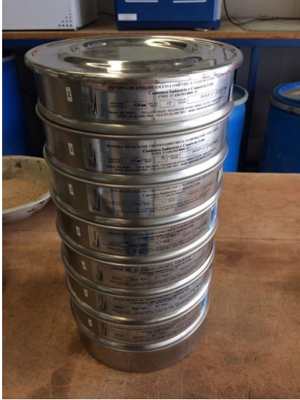
Figura 47 – Série de peneiras para ensaio de granulometria da areia.
