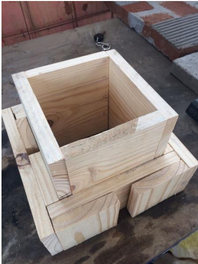
Figura 48 – Fôrma de madeira desenvolvida para este trabalho.
