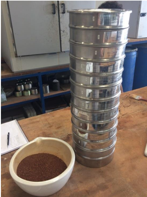
Figura 38 – Série de peneiras para o ensaio de granulometria do solo.
