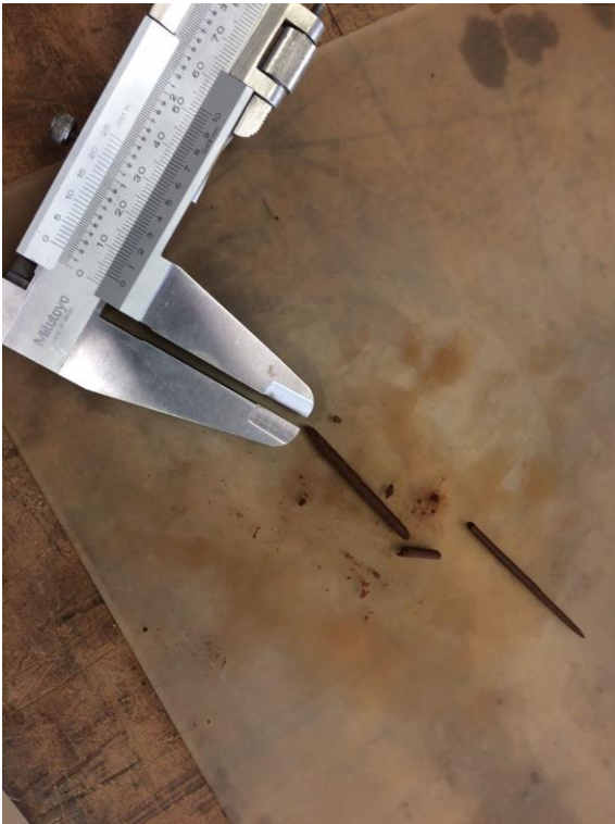
Figura 42 – Cordão com 3 mm de espessura, para determinação do Limite de plasticidade.
