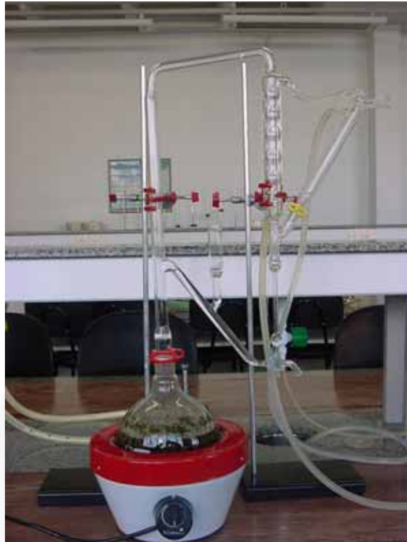
FIGURA 6 - Sistema de extração de óleos voláteis com extrator do tipo Clevenger modificado.
