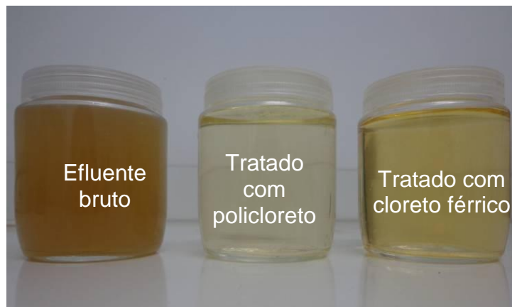
Figura 11 - Efluente saída final e após passar pelo tratamento
