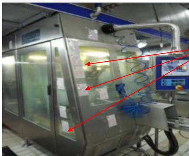
Etiquetas fixadas na máquina próximas ao local das anomalias, para identificar o item a ser consertado.
