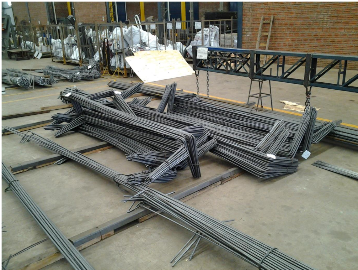
Figura 4 – Fornecimento de aço cortado e dobrado
