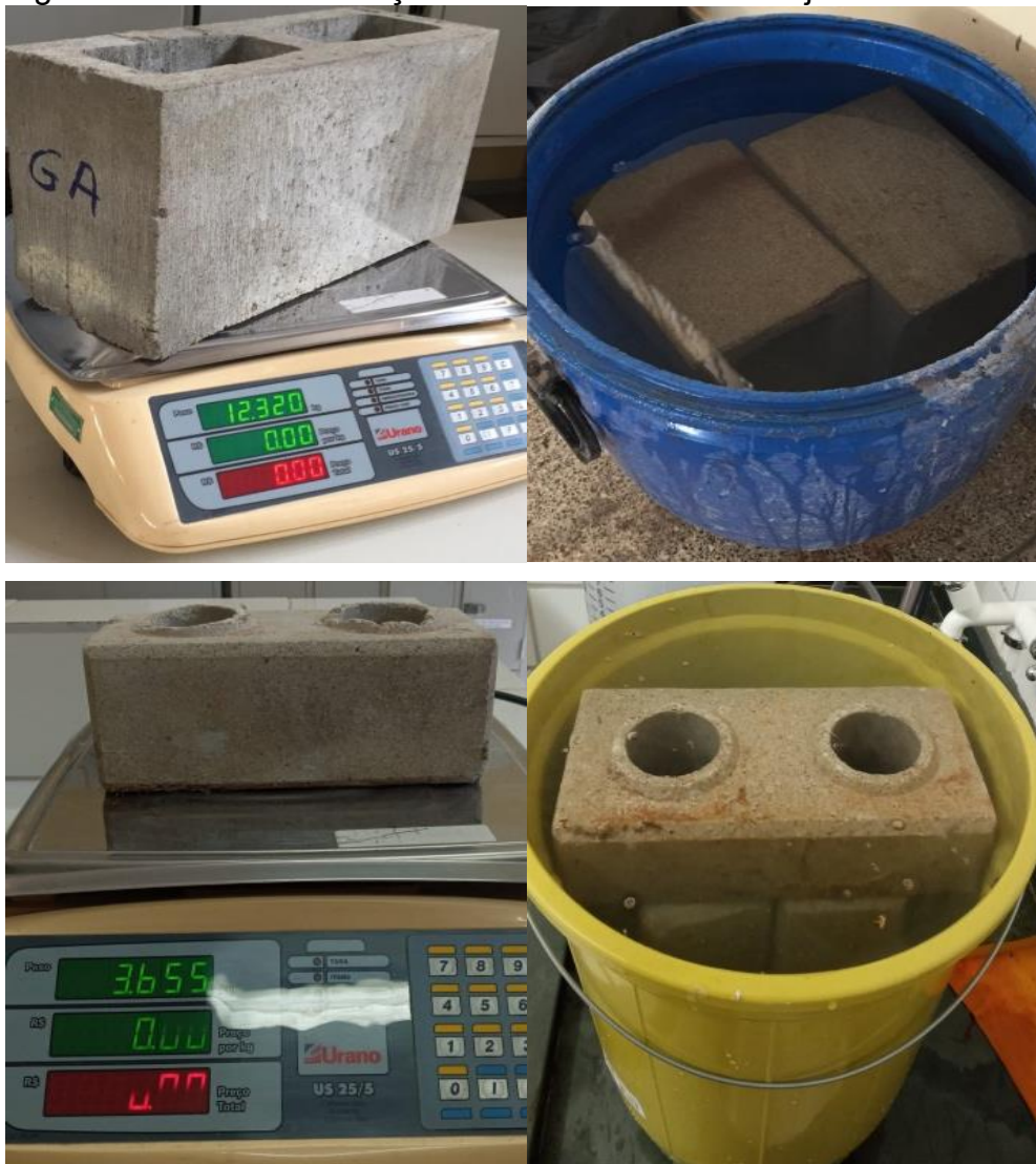
Figura 17 - Teste de absorção umidade dos blocos e tijolos
