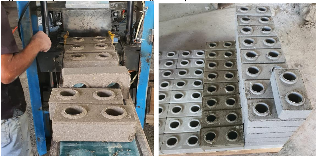
Figura 14 - Tijolos solo-cimento-serragem em processo de cura
