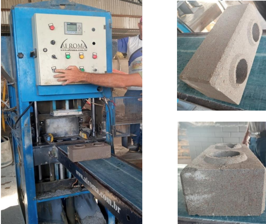
Figura 13 - Fabricação do tijolo-solo-cimento serragem prensa hidráulica
