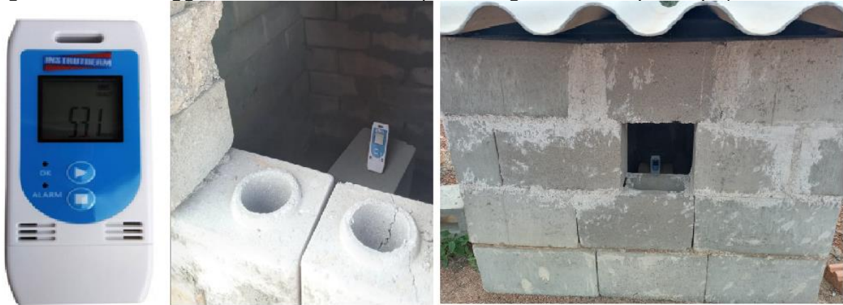
Figura 22 - Datalogger HT900 Instrutherm (termo higrômetro no protótipo)
