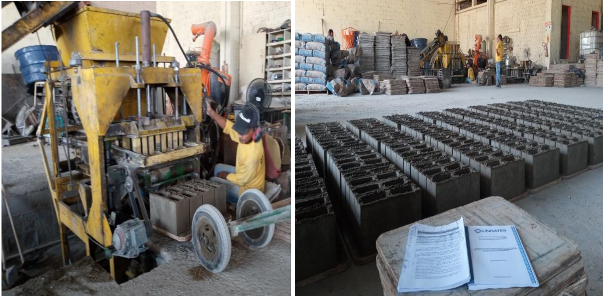
Figura 11 - Fabricação dos Blocos Cimento-serragem na vibro-prensa
