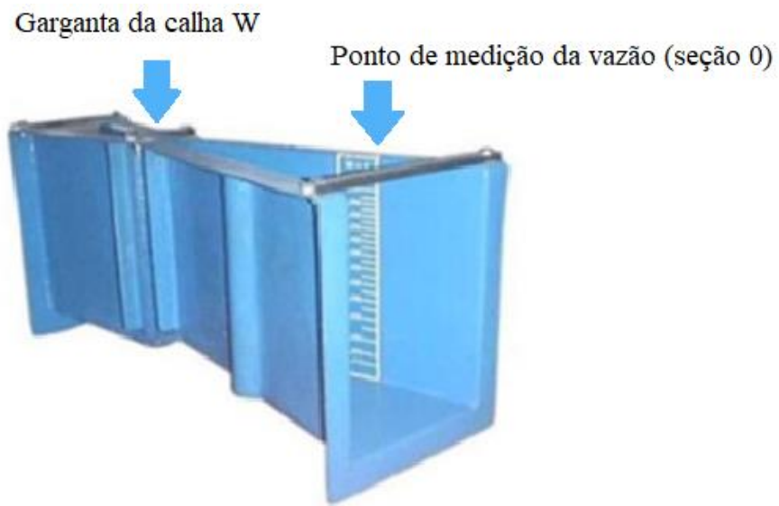
Figura 26 - Identificação das seções da Calha Parshall
