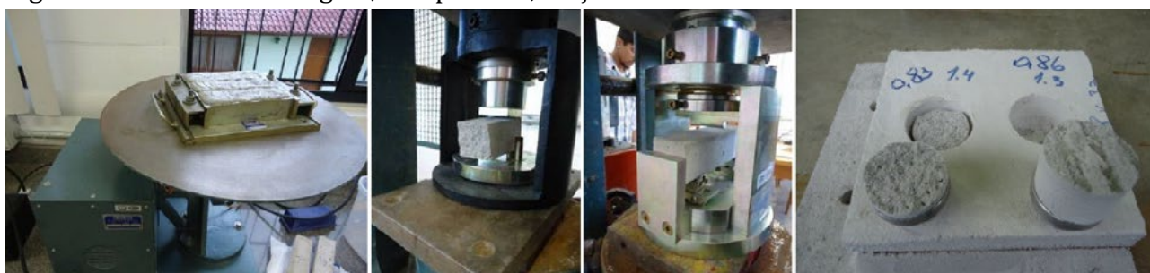
Figura 2 – Ensaio: moldagem, compressão, tração na flexão e aderência.
