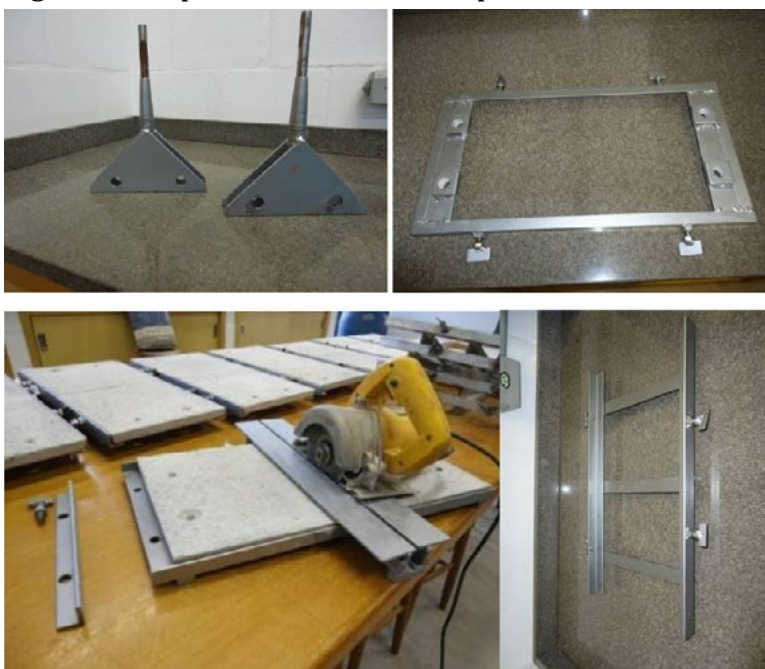
Figura 5 – Suportes desenvolvidos para executar os moldes e efetuar os ensaios.
