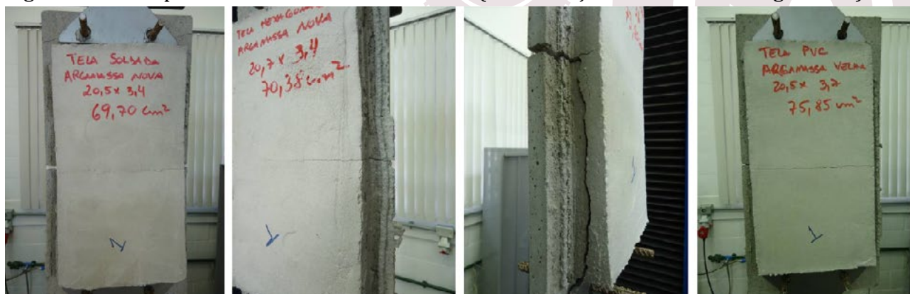
Figura 11 – Rompimento dos moldes aos 28 dias (estruturação da camada de argamassa).
