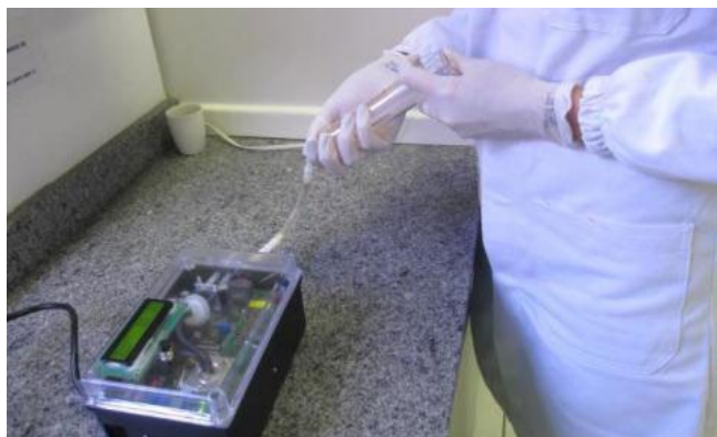
Figura 2. Sensor específico para a medição de metano em misturas gasosas.
