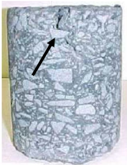
Figura 2 - Trincamento Top-Down Cracking
