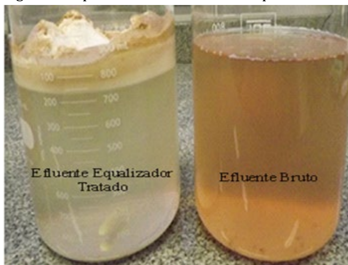
Figura 6. Aspecto do efluente antes e após a eletrocoagulação.
