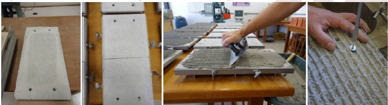
Figura 6 – Perfuração, divisão, chapisco e fixação da tela para situação de transmissão de tensões.
