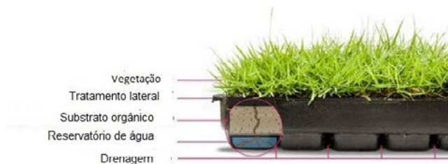
Figura 1. Estrutura telhado verde
