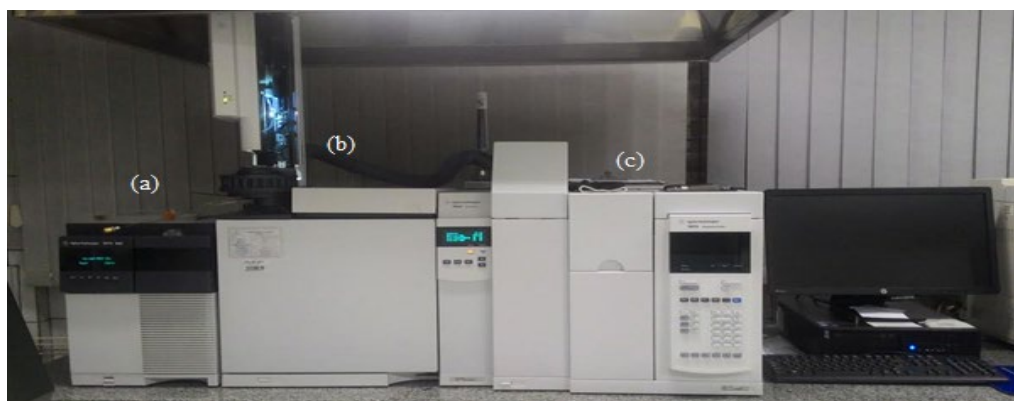
Figura 1 - Cromatógrafo gasoso (a), Espectrômetro de massa (b) e amostrador Headspace (c)
