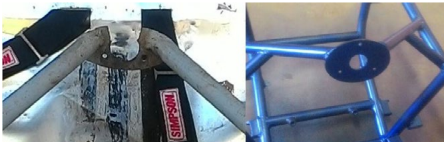
Figura 4. Antes e depois do suporte da direção.
