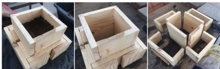
Figura 1. Fôrma de madeira desenvolvida para a moldagem dos corpos de prova.
