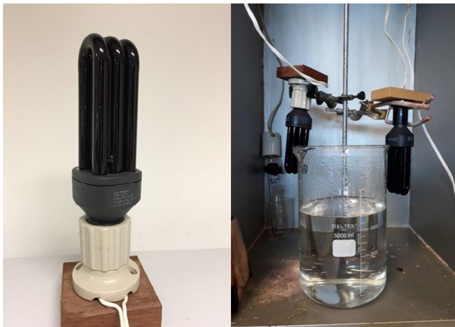
Figura 1 – (a) Lâmpada de luz negra utilizada nos experimentos e (b) sistema de POA implementado.
