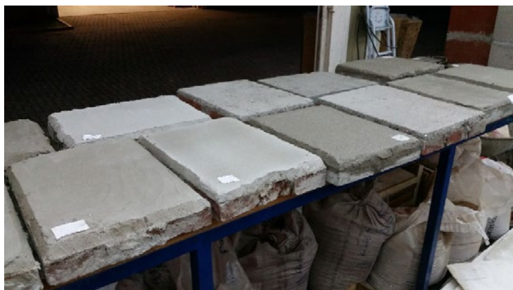
Figura 2. Placas de concreto e cerâmica com argamassa de revestimento
