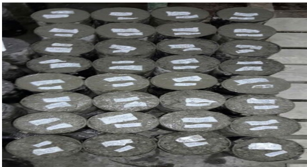
Figura 2. Corpos de Prova para ensaio de compressão, confeccionados no Laboratório da Universidade do Vale do Taquari.
