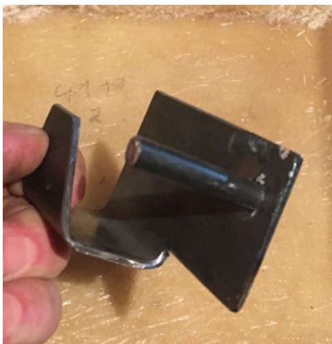
Figura 02 – Gancho metálico para fixação dos módulos
