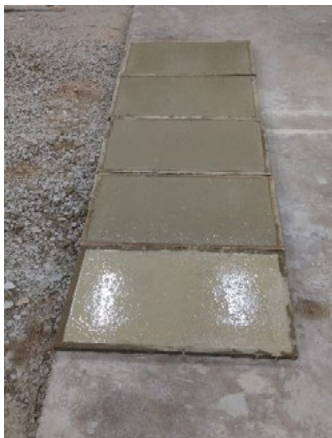
Figura 1 – Substratos de concreto que receberam os traços que variam de 0 a 100%.
