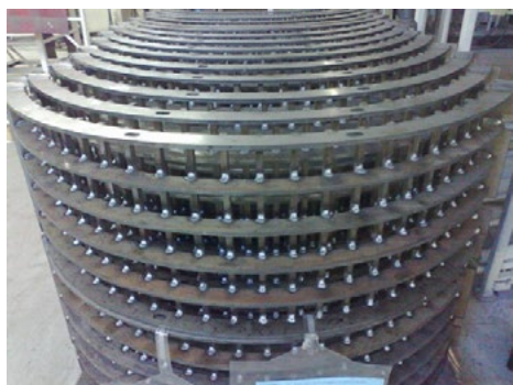
Figura 1. Componente de grandes dimensões manufaturado utilizando soldagem de SAE 1045.
