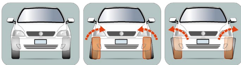
Figura 6. Cambagem negativa e positiva
