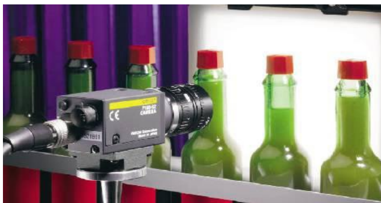
Figura 1- Imagem ilustrativa de um sistema de visão computacional para inspeção do nível de enchimento de embalagens
