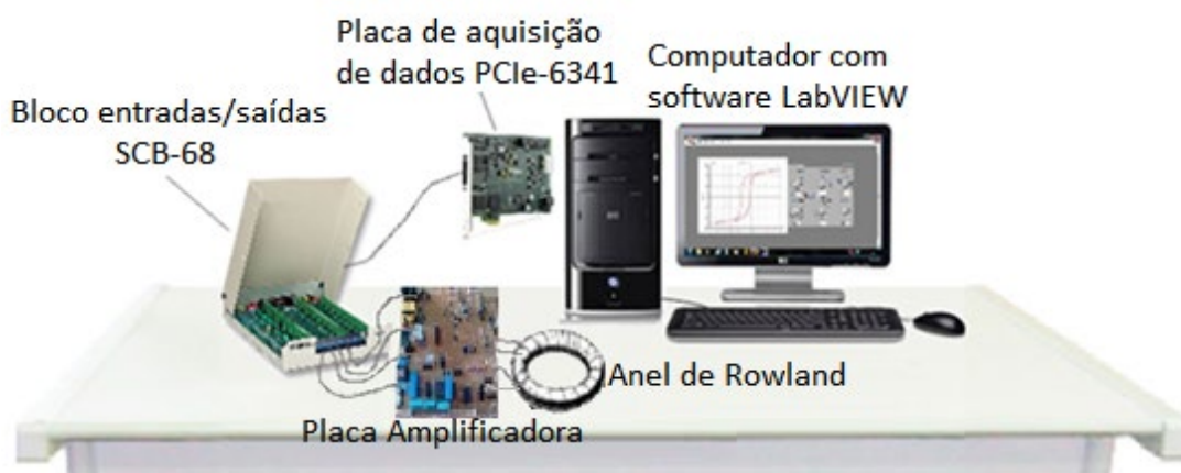
Figura 1- Plataforma de instrumentação virtual
