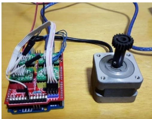
Figura 3 – Teste de ligação do motor Fonte: Autor (2017)
