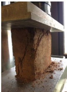
Figura 3. Relatório referente a ruptura dos três corpos de prova; corpo de prova submetido a compressão.
