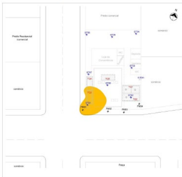
Figura 2. Pluma do contaminante benzeno verificada na área de estudo, bem como localização das sondagens representativas e coletas de solo realizadas no local.
