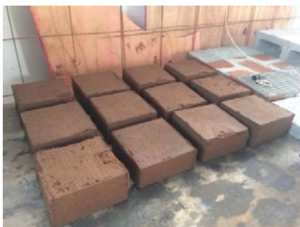
Figura 2. Corpos de prova moldados.
