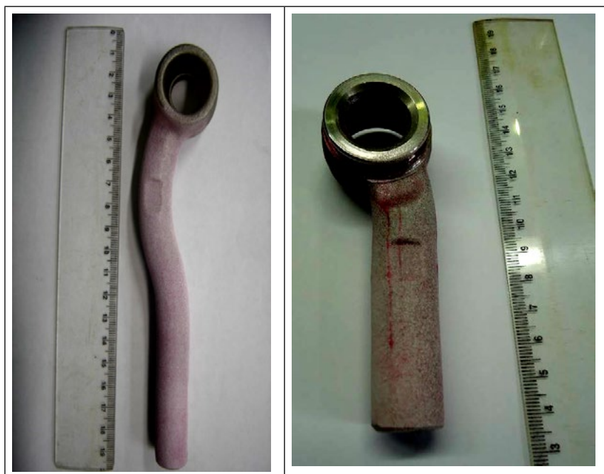
Figura 3. Inspeção por LP: (esquerda) dobra 0,3 mm não visível, (direita) dobra 0,5 mm visível.
