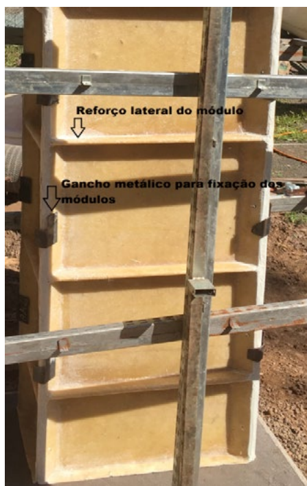
Figura 01. Fôrma composta por módulos em fibra de vidro reforçada com material de núcleo.
