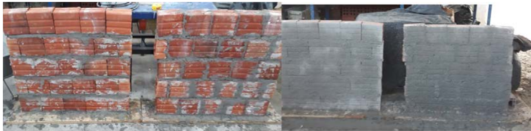
Figura 2: Paredes em desenvolvimento para realização dos ensaios.
