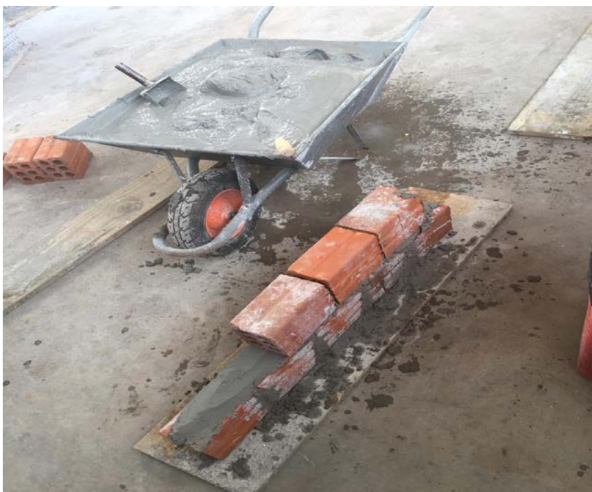
Imagem 1. Execução das mini-paredes.
