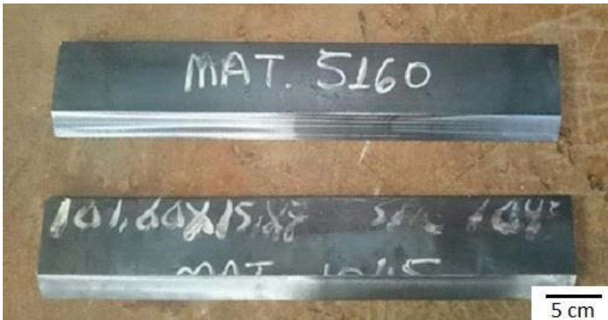
Figura 4 - Barras após o processo de usinagem do gume.
