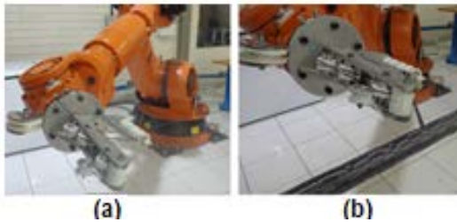
Figura 1. (a) Robô KUKA, (b) Enrolamento filamentar
