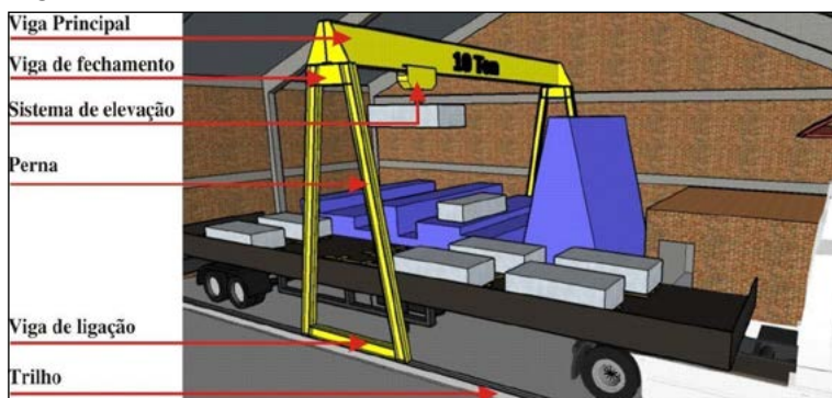
Figura 2. Simulação do Pórtico Rolante no local aonde será instalado.
