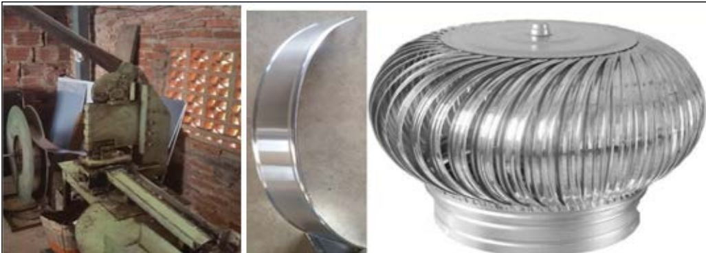
Figura 1. Fabricação do exaustor eólico.
