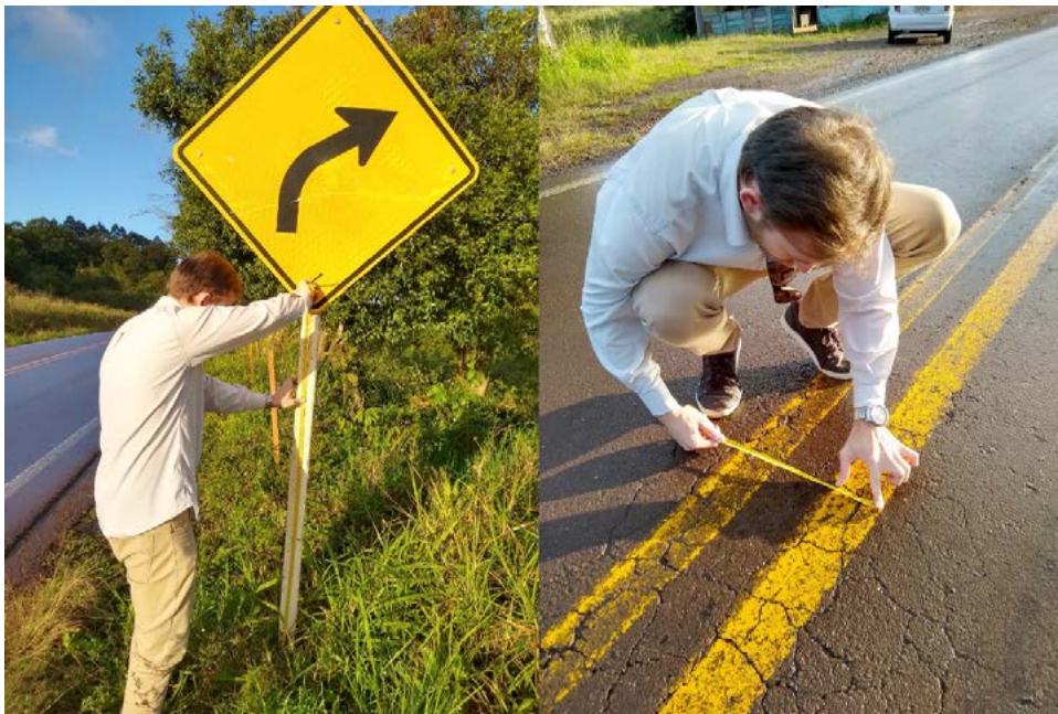
Figura 1. Medida das dimensões utilizando trena.
