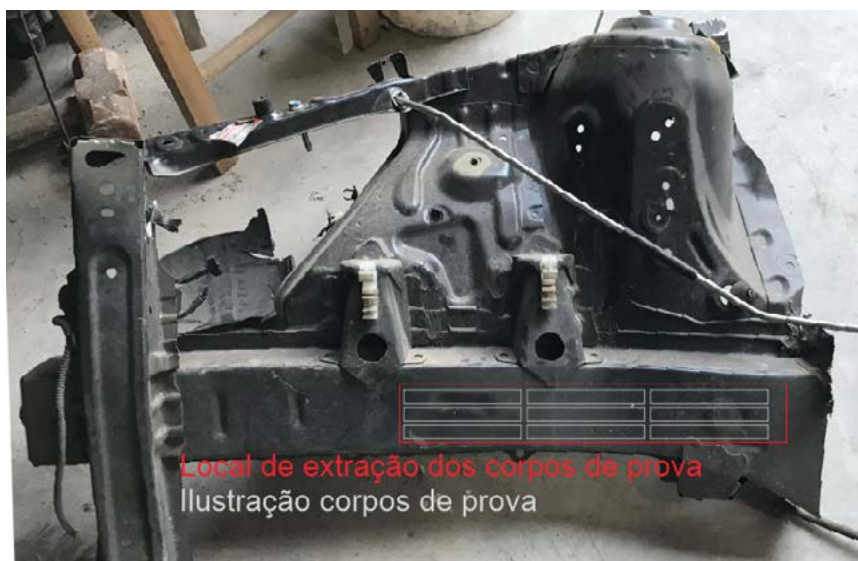
Figura 2 – Local de extração dos corpos de prova
