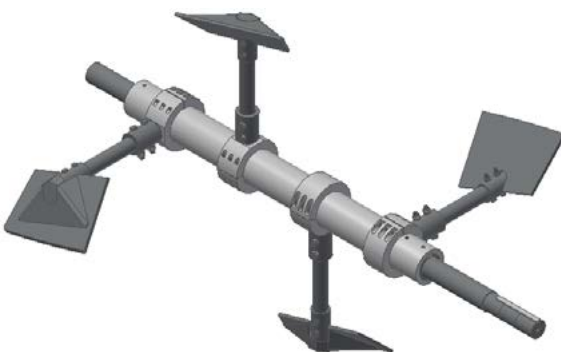
Figura 2. Conjunto eixo Misturador 2000 Kg
