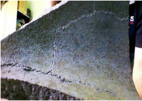
Figura 2 – Defeito na face interna da peça em estudo
