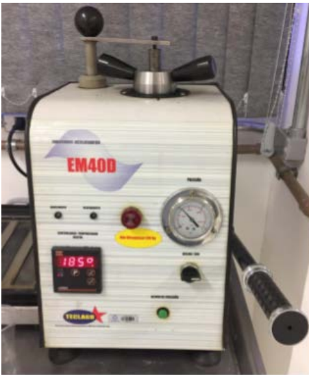
Figura 4. Embutidora modelo EM40D
