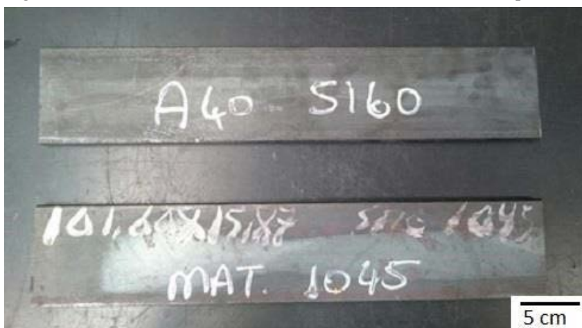
Figura 3 - Barras de aço SAE 5160 e SAE 1045 no estado em que foram fornecidas.
