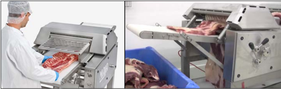
Figura 1. Máquina descouradeira automática em operação.
