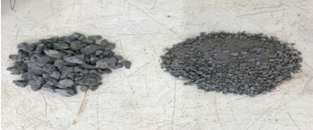
Figura 1. Amostras de agregados graúdos e miúdos reciclados de concreto.
