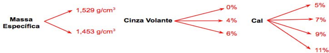
Figura 1. Combinação dos corpos de prova.
