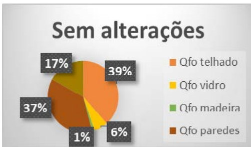
Gráfico 03 – Carga térmica absorvida no dormitório 2, estando sem alterações.
