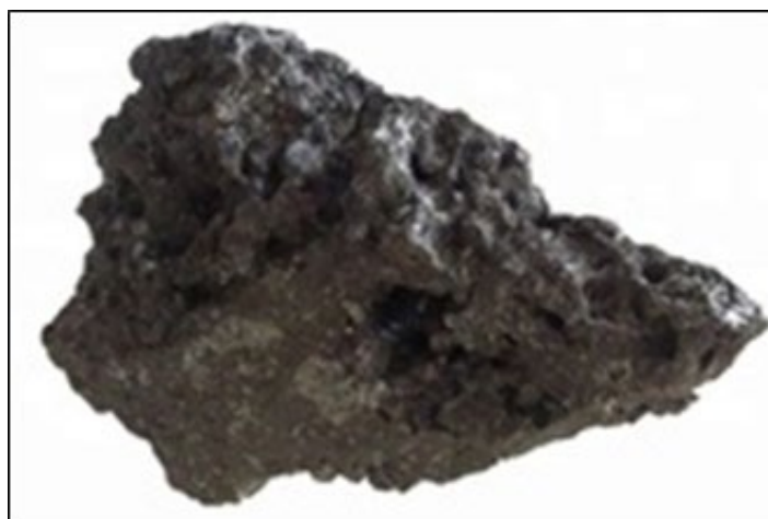
Figura 1 – Escória de ferro utilizada como eletrodos.
