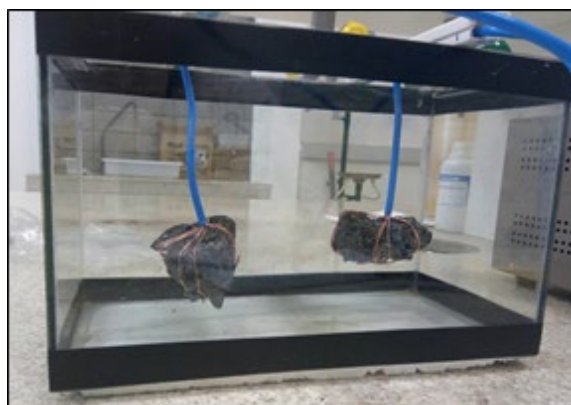
Figura 1 – Reator e escórias de ferro utilizadas como eletrodo no tratamento.
