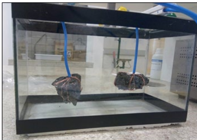
Figura 2 – Reator e escórias de ferro utilizadas como eletrodo no tratamento.
