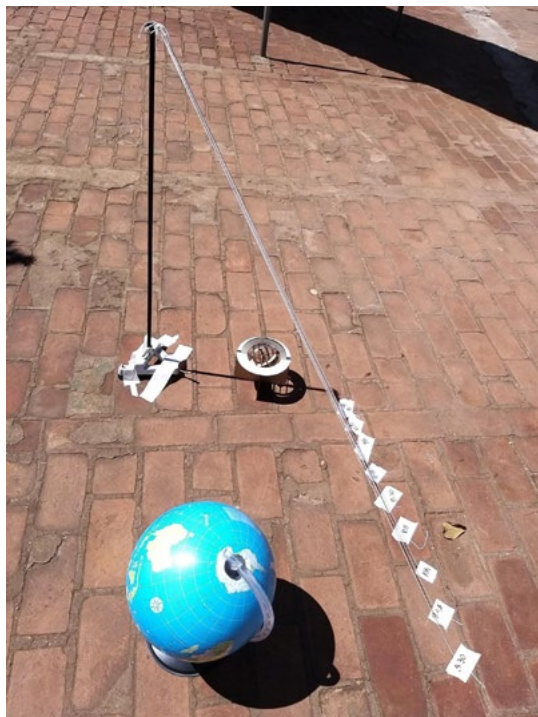
Figura 8 - Gnômon fixo ao chão e medidas sendo realizadas.
