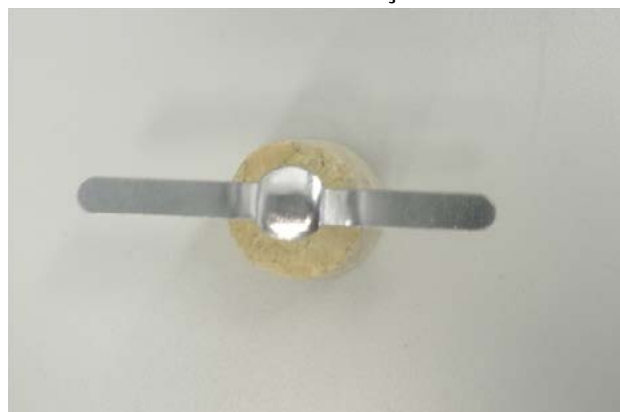
Figura 6.4: bússola produzida de forma similar, substituindo a massa de modelar por uma rolha de cortiça.
