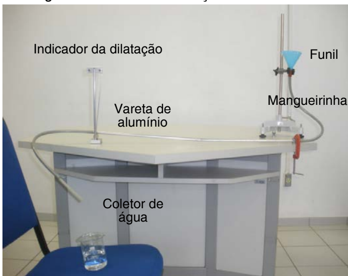
Figura 6: Circuito de dilatação com indicador.
