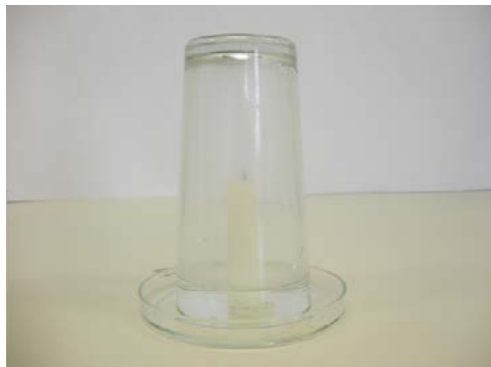
Figura 3: quando a vela apaga, sobe o nível de água dentro do copo.
