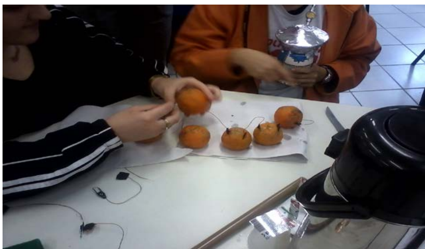
Figura 3: O fio ligado ao clipe de um limão fica ligado à moeda do próximo, e assim sucessivamente
