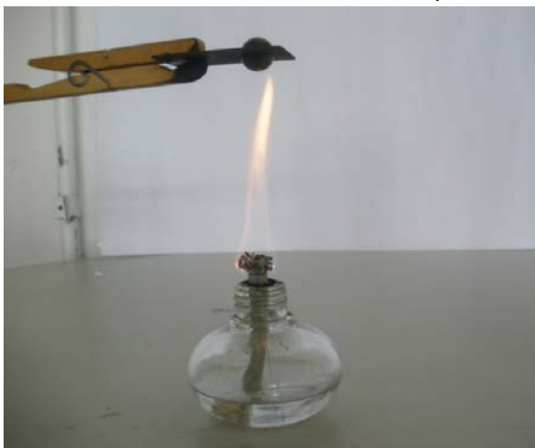
Figura 5: As dimensões de um orifício se dilatam quando ele é aquecido.
