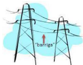
Figura 7: Dilatação de fios.
