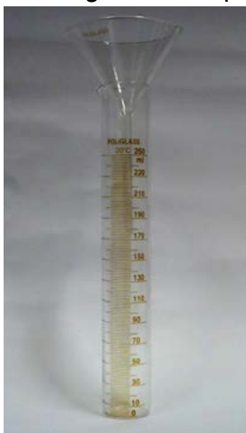
Figura 11: Montagem de um pluviômetro.
