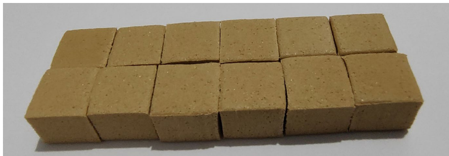
Figura 3 – Prisma com dimensões 6 cm x 2 cm x 1 cm (comprimento, largura e altura)
