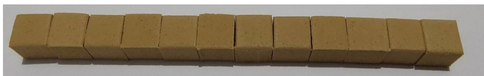
Figura 2 - Prisma com dimensões 12 cm x 1 cm x 1 cm (comprimento, largura e altura)
