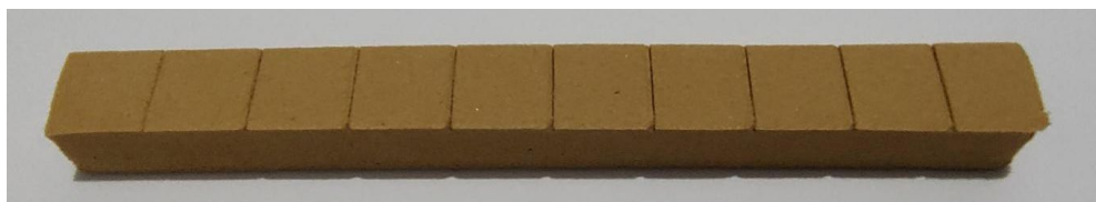
Figura 5 - Prisma de dimensões 10\text{ cm} \times 1\text{ cm} \times 1\text{ cm} (largura comprimento e altura)
