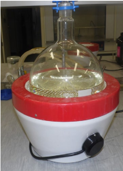
Figura 9: Aquecimento em manta
