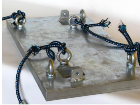
Figura 3 – Foto do Gabarito com cordas de fixação
