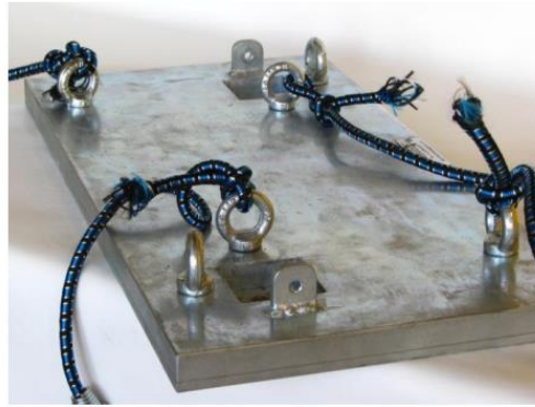
Figura 3 – Foto do Gabarito com cordas de fixação
