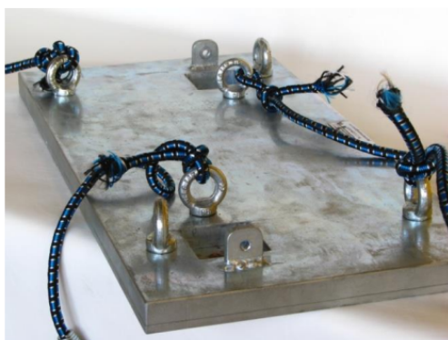
Figura 3 – Foto do Gabarito com cordas de fixação
