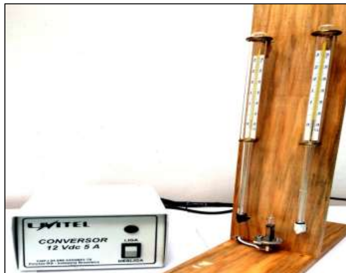
Figura 5 – Montagem do equipamento para radiação.
