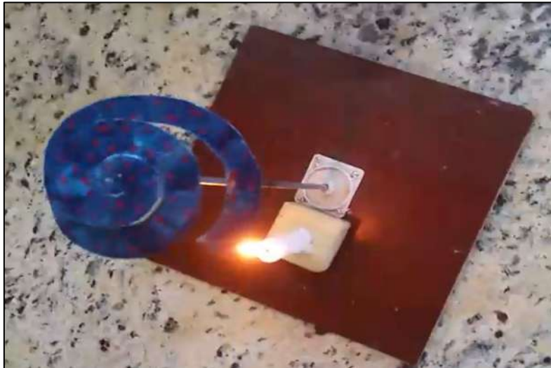
Figura 3 – Montagem do equipamento para a convecção
