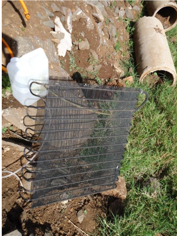
Figura 3: Aquecedor solar confeccionado com uma grade de geladeira. Fonte: da autora.
