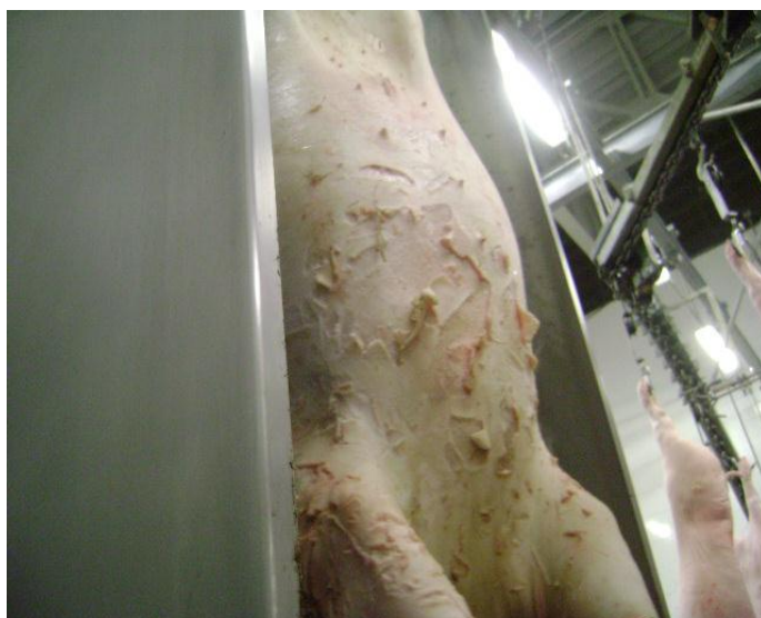
Figura 2- Carcaça após escaldagem a 62° C.
