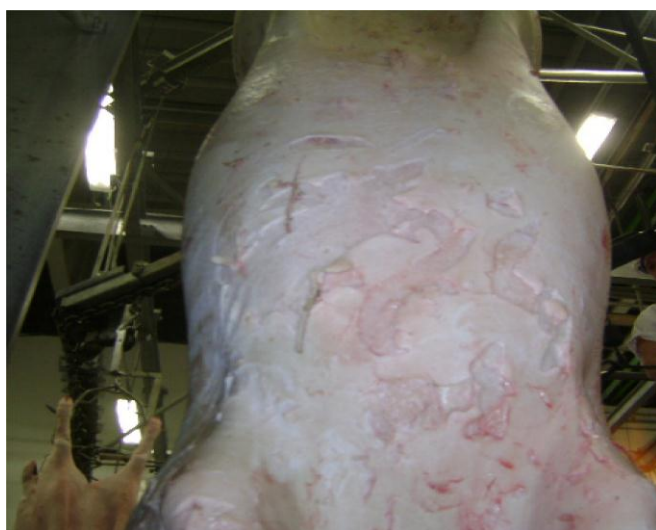
Figura 3- Carcaça após escaldagem a 61° C.
