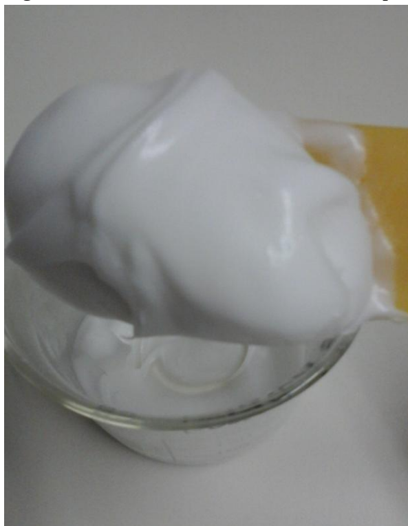
Figura 2 – Creme com as trocas de ceras, aparentemente sem separação das fases:
