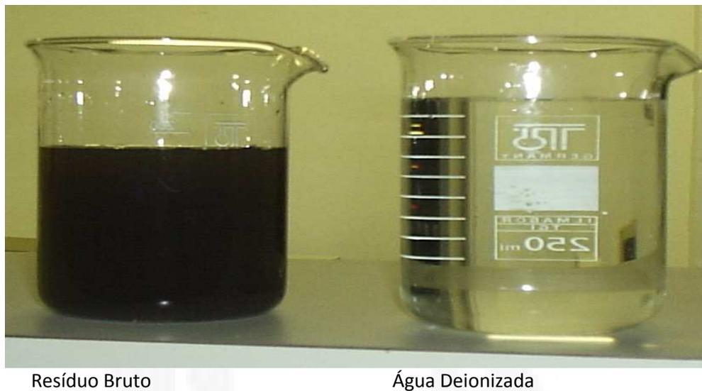
FIGURA 7 - Resíduo bruto (primeiros experimentos) do curtume sem nenhum tratamento em contraste com a água deionizada utilizada para a limpeza dos equipamentos
