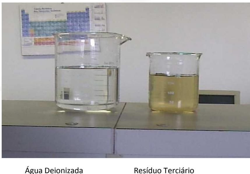
FIGURA 8 - Resíduo terciário do curtume em contraste com a água deionizada utilizada para a limpeza dos equipamentos.
