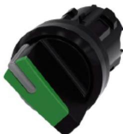
Interruptor com manípulo, iluminável, 22 mm, redondo, plástico, verde, manípulo, curto, 2 posições de comutação O-I, de encaixe, ângulo de comutação 90°, 10:30h/13:30h
