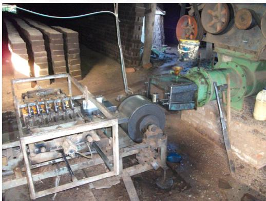
Figura 4 - Maromba e cortador de tijolos
