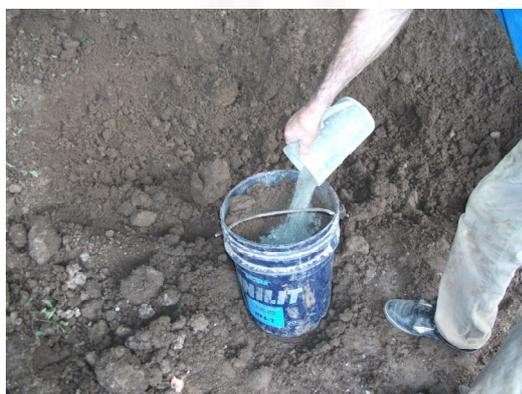
Figura 5 - Adição de lodo de serra à massa cerâmica
