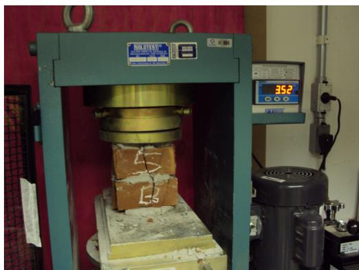
Figura 10 - Prensa com os corpos de prova utilizada para o teste de resistência à compressão
