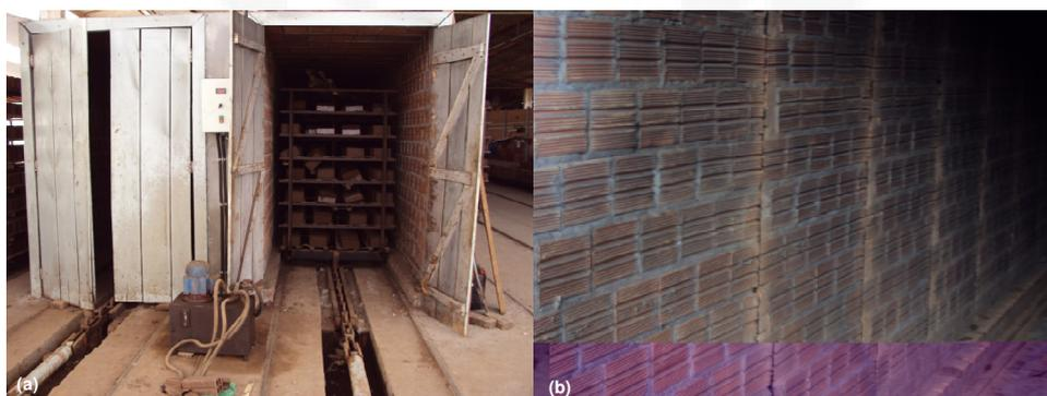
Figura 6 - Visão da entrada do secador e as fendas por onde o calor sai para secar os tijolos (a) entrada do secador; (b) “gateiras”
