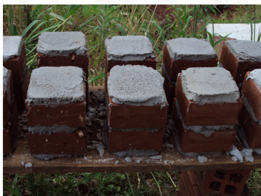
Figura 9 - Blocos de tijolo e argamassa preparados para o teste de resistência à compressão
