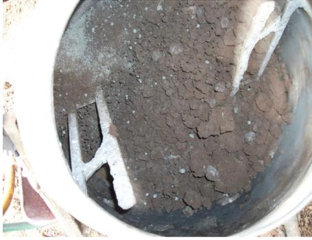
Figura 3 - Lodo de serra sendo incorporado à massa cerâmica
