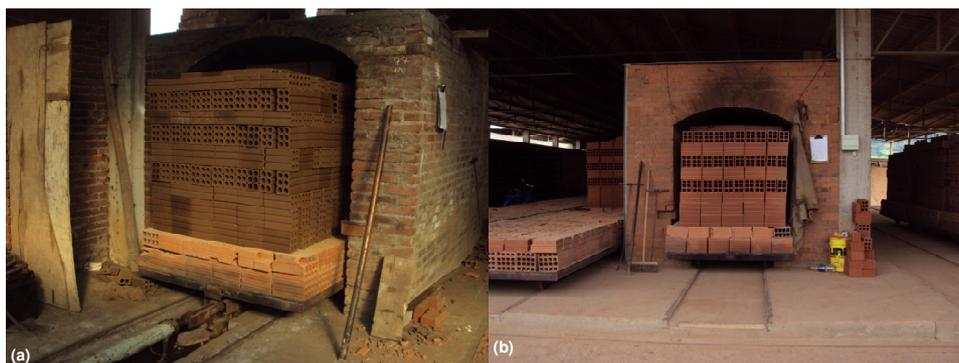
Figura 7 - Entrada dos produtos no forno (a); saída dos produtos queimados do forno (b)
