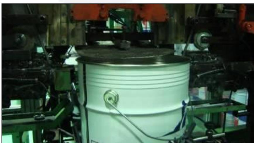
Figura 28 - Regulagem do cabeçote da máquina de alça.
