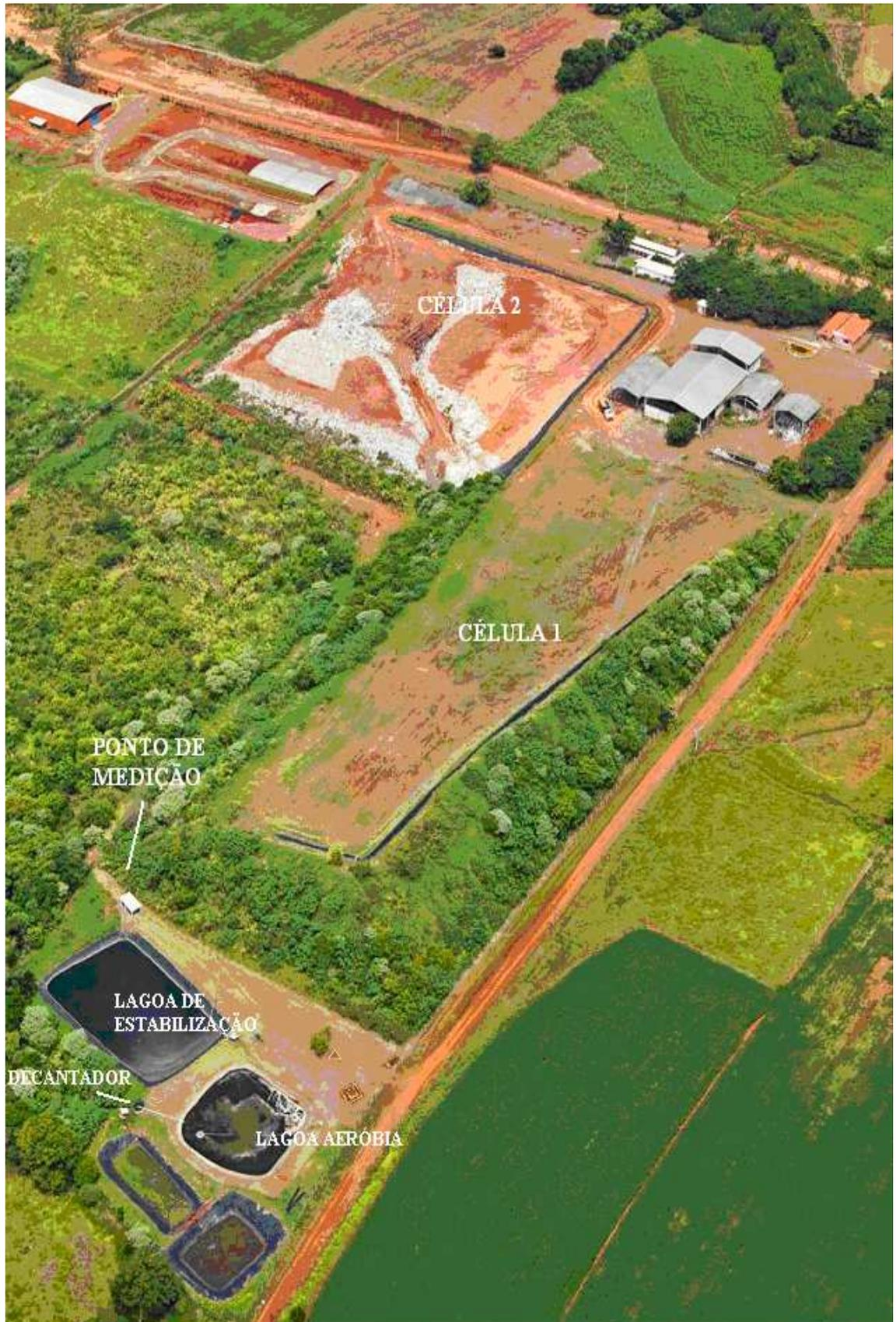
FIGURA 4 - Vista aérea do Aterro Sanitário de Lajeado/RS
