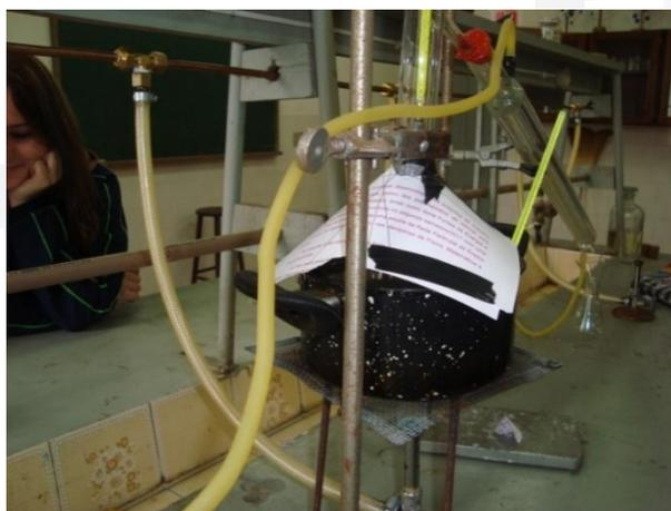
Figura 9: Adaptação realizada no destilador para aproveitamento do calor.
