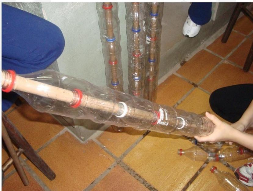
Figura 19: Construção do aquecedor solar com materiais alternativos.
