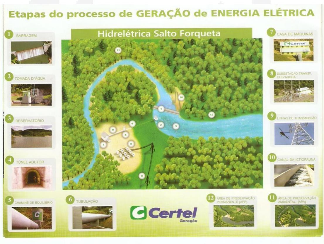
Figura 15: Etapas do processo de geração de energia elétrica na PCH Salto do Forqueta.
