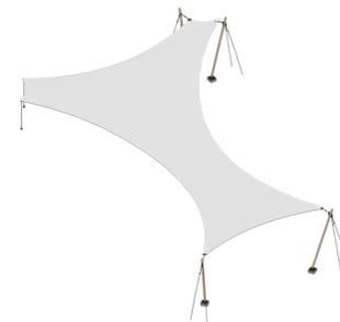
Para a lona tensionada proposta para a cobertura do núcleo central da aldeia, preveu-se a fixação da mesma junto ao chão em 3 pontos, além do tensionamento até um quarto ponto. Sua materialidade será branca e alto limpante, facilitando sua manutenção
