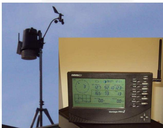
Figura 14 – Estação meteorológica
