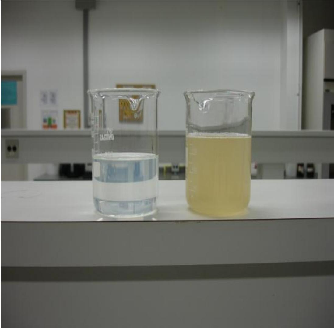
Figura 8: Foto comparativa do efluente tratado (carvão ativado) x efluente bruto 13/09/2011.
