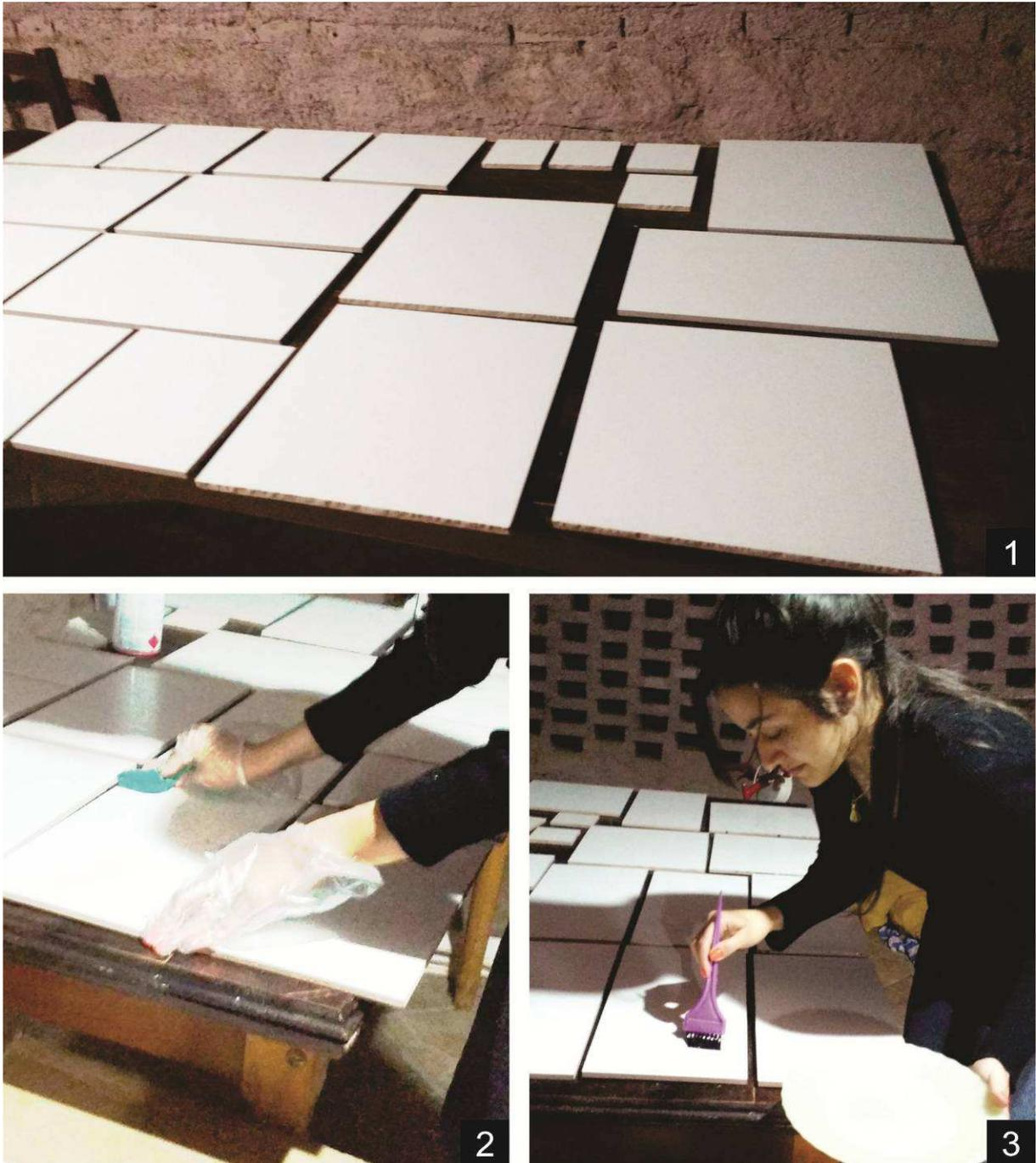
Fonte: Da autora, peças cortadas (1), limpeza das peças com solvente (2) e aplicação da resina de poliéster (3).
