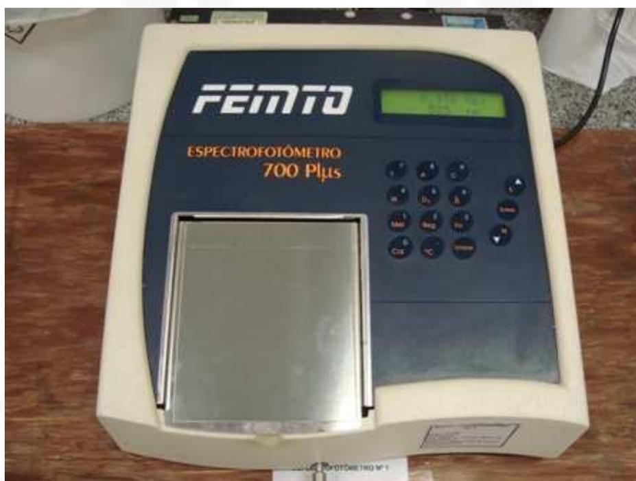
**Figura 4** - Espectrofotômetro 700plus de marca Femto de feixe simples.
