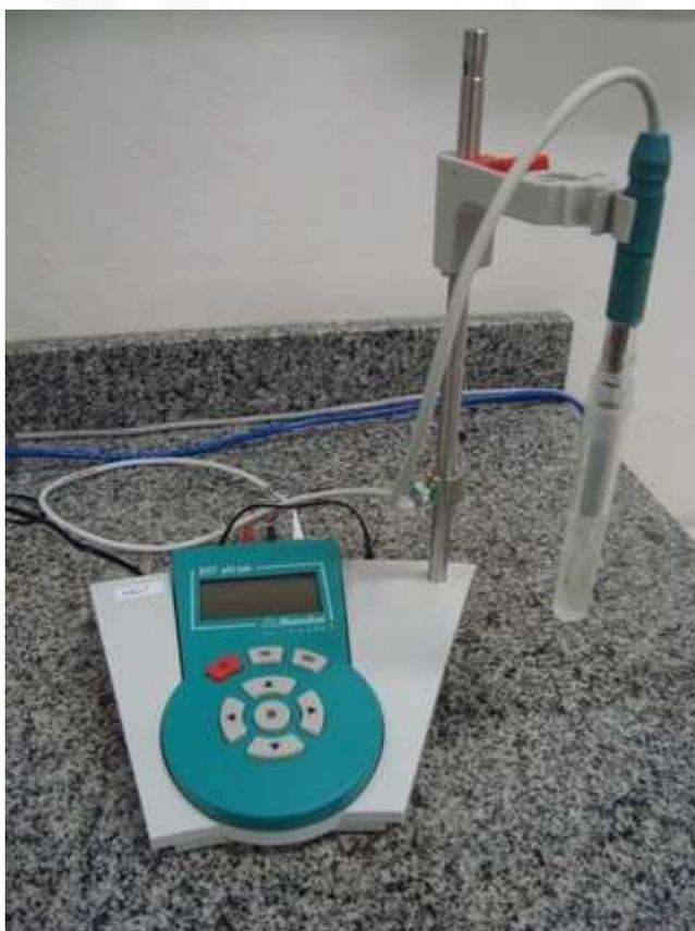
**Figura 10** – Aparelho pHmetro de bancada 827 de marca Metrohm.
