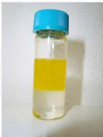
**Figura 9** – Óleo de linhaça diluído em éter etílico P.A. e  $H_2O_2$ , resultando em mistura heterogênea.
