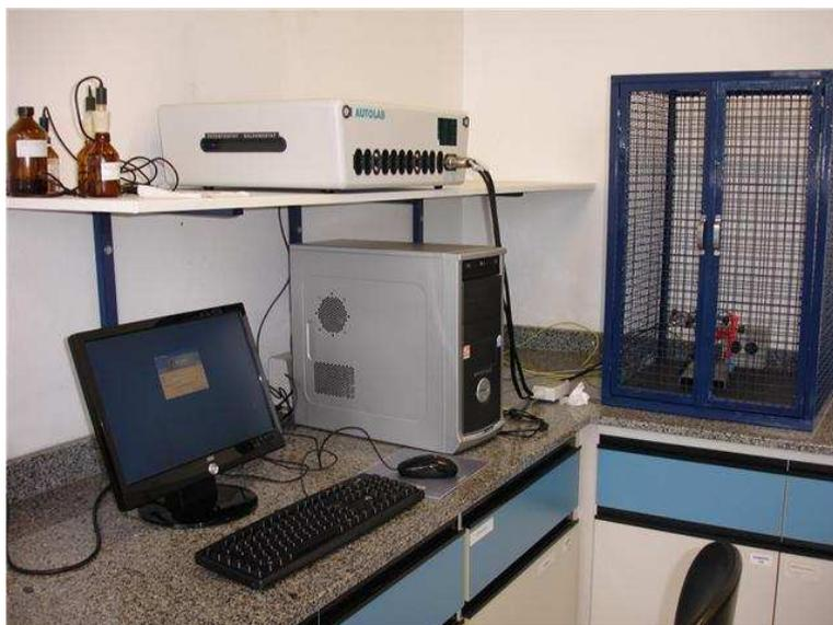
**Figura 11** - Potenciostato PGSTAT 128N de marca Autolab acoplado a um microcomputador.
