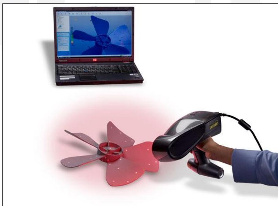
Figura 5 – Processo de obtenção de malha tridimensional (via *scanner* a laser)
